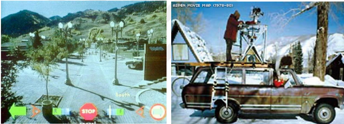
Şekil 2.7. Aspen Film Haritası simülasyon arayüzü (sol) ve kamyonet üstündeki kameralar (sağ) (Aspen Movie Map, 2020)
