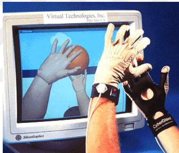
Şekil 2.21. DataGlove (Veri Eldiveni) ve sanal dünyadaki yansıması (Data Glove, 2020)
