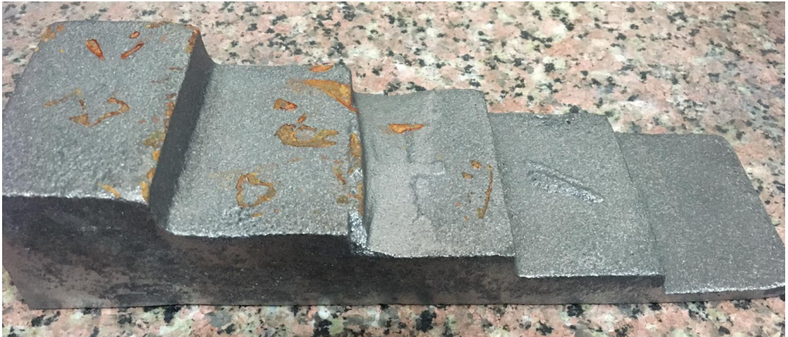
Şekil 3.4 Döküm işlemi sonrası elde edilen basamak kalıp numune
