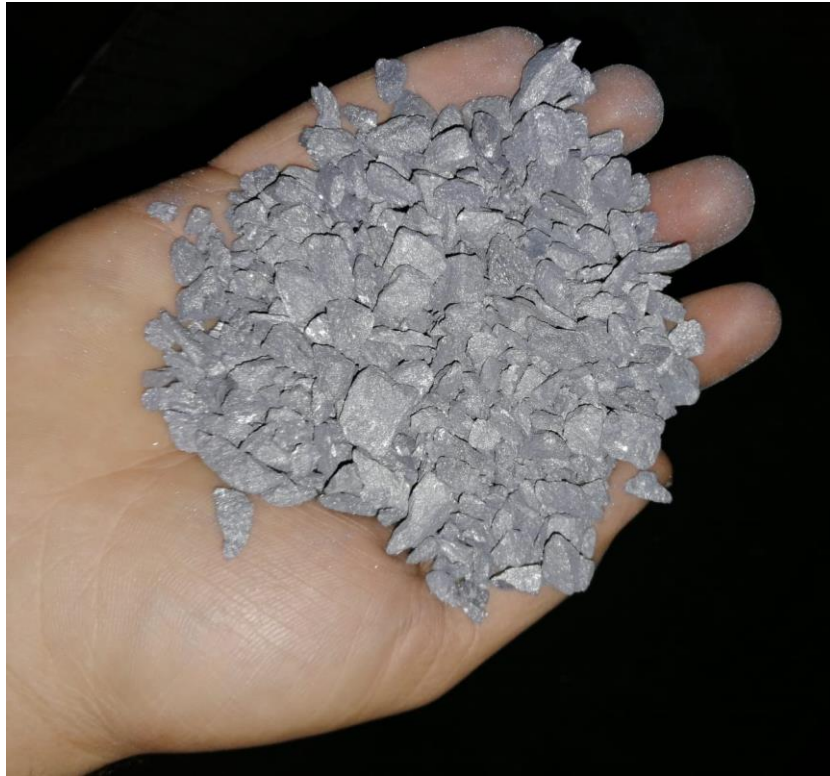
Şekil 3.1 Çalışmada kullanılan 2-10mm tane boyut aralığındaki FeSiMg küreselleştiricisi
