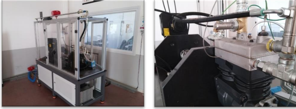
Şekil 4.2. Hava kompresörünün deneysel çalışmalarının yapıldığı test düzeneği
