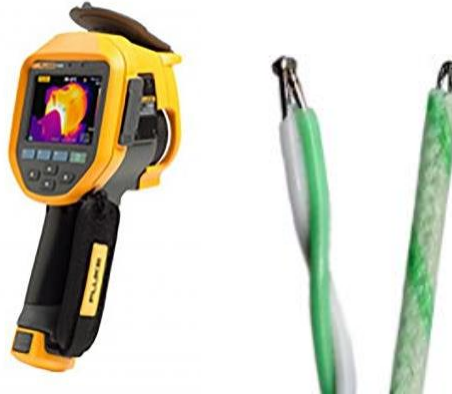
Şekil 4.7. Sıcaklık ölçümünde kullanılan termal kamera ve termokupullardan örnekler
