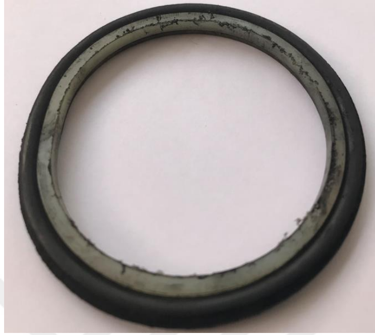
Şekil 4.2. Aşınarak sızdırma sağlayamayan sızdırmazlık elemanı
