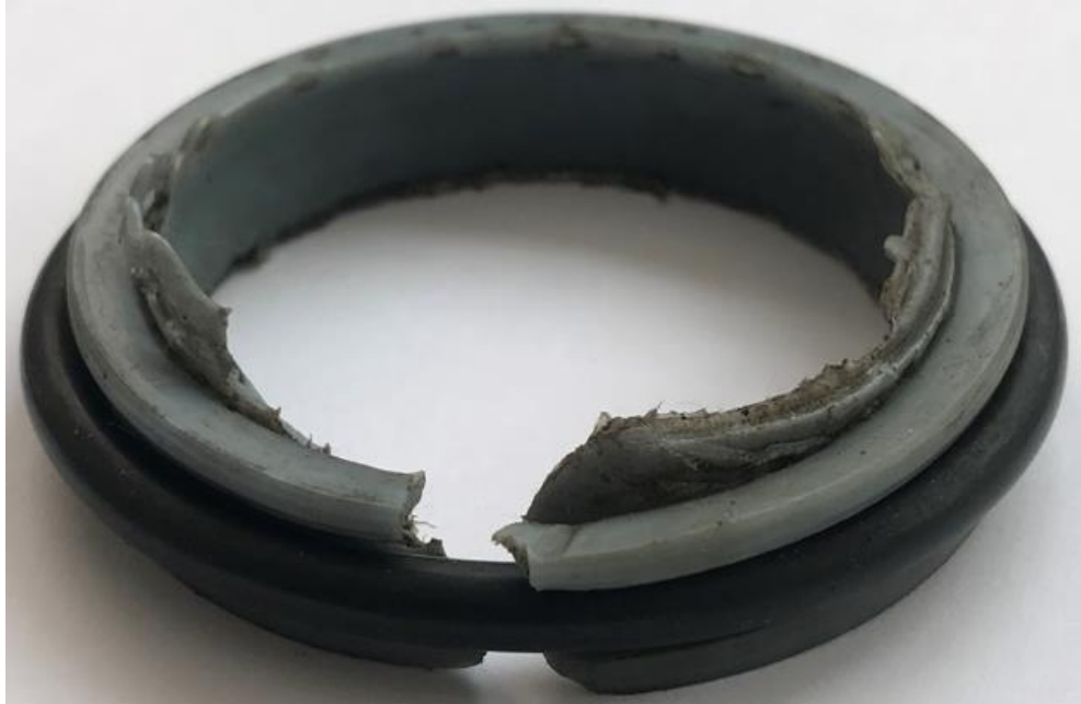
Şekil 4.3. Dizel etkisi sonu parçalanma şeklinde hasara uğrayan sızdırmazlık elemanı
