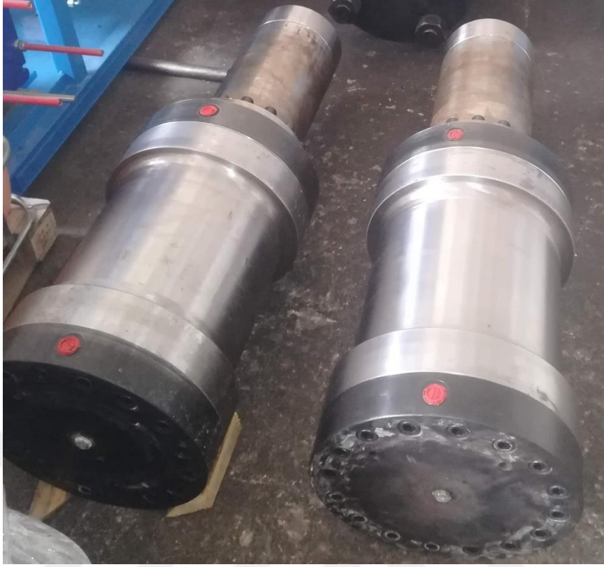
Şekil 3.1. Deneylerde kullanılan TÜRKAV Firmasına ait basınç yükselticiler
