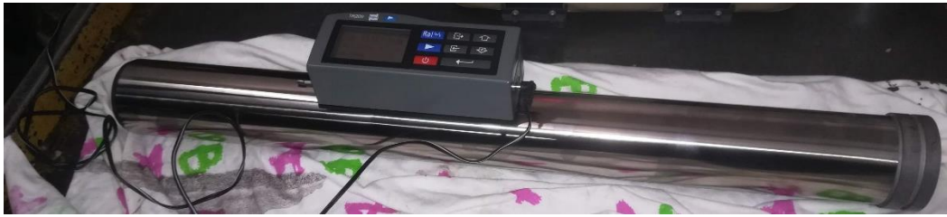
Şekil 3.6. İki farklı yüzey pürüzlülüğü değerine sahip olacak şekilde üretilen mil
