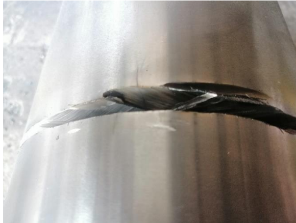
Şekil 3.17. 1-4. Deneylerde kullanılan BY'de 76500 çevrimde meydana gelen çatlama problemi
