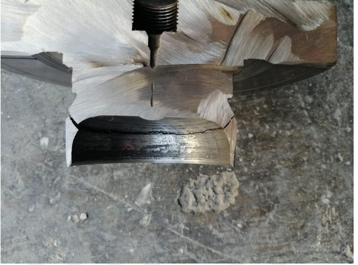
Şekil 3.15. İkinci çatlamadaki çatlak bölgesi
