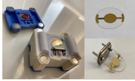
Şekil 3.8. Deneysel olarak kullanılan openQCM sisteminin ekipmanları
