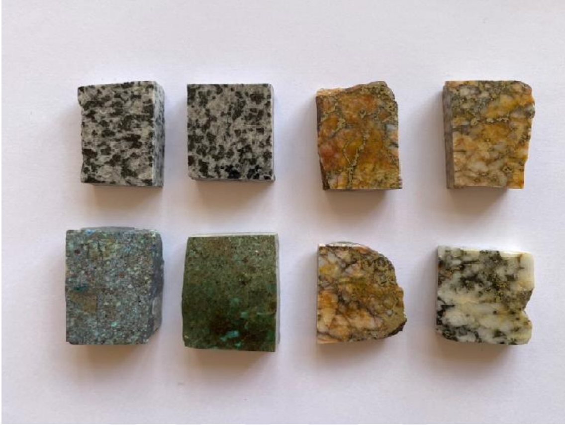
Şekil 6. Goşgardağ cevherleşme alanından alınan örneklerden yapılmış parlatma kesit fotoğrafları
