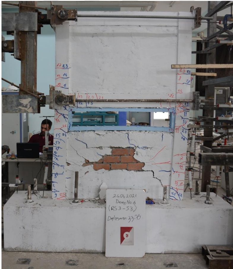
Şekil 4.182. R3-S3 numunesinin -5 çevriminde oluşan çatlaklar
