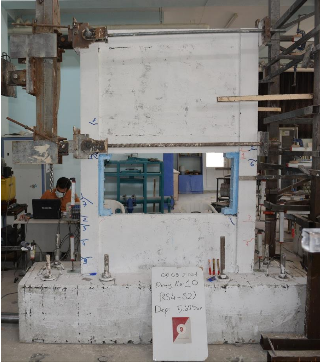
Şekil 4.146. R4-S2 numunesinin +3 çevriminde oluşan çatlaklar
