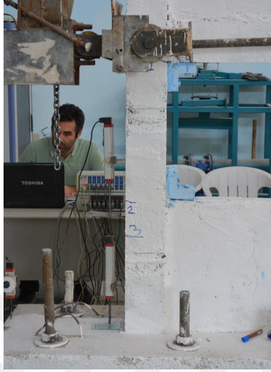
Şekil 4.96. R4-S1 numunesinin +1 çevriminde oluşan çatlaklar
