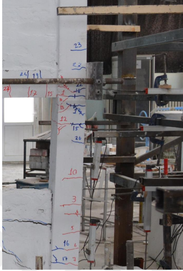
Şekil 4.55. R4 numunesinin +5 çevriminde oluşan çatlaklar
