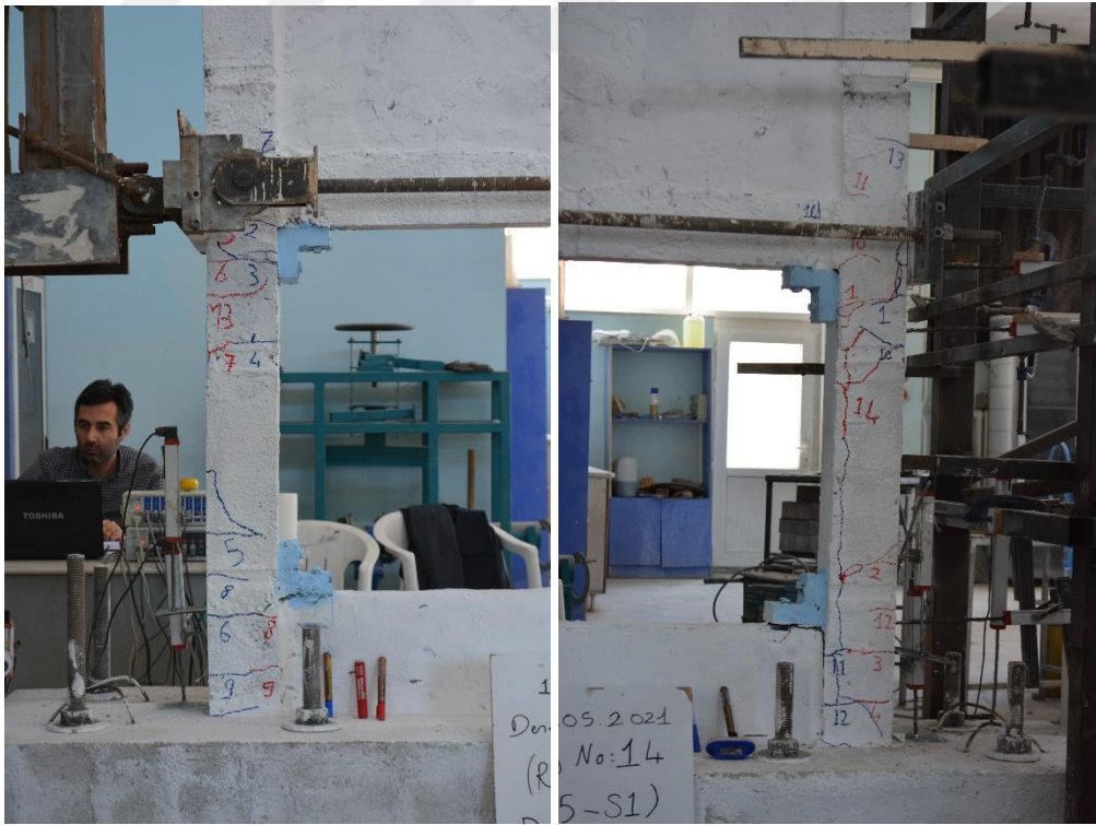
Şekil 4.117. R5-S1 numunesinin +5 çevriminde oluşan çatlaklar
