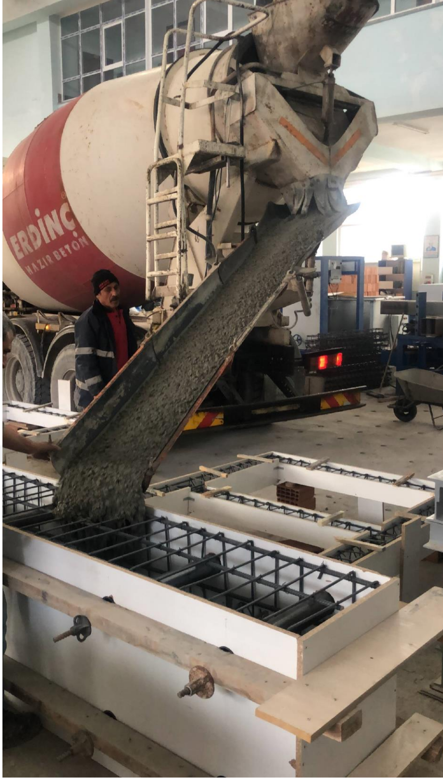
Şekil 3.13. Numunelere beton döküm işlemi
