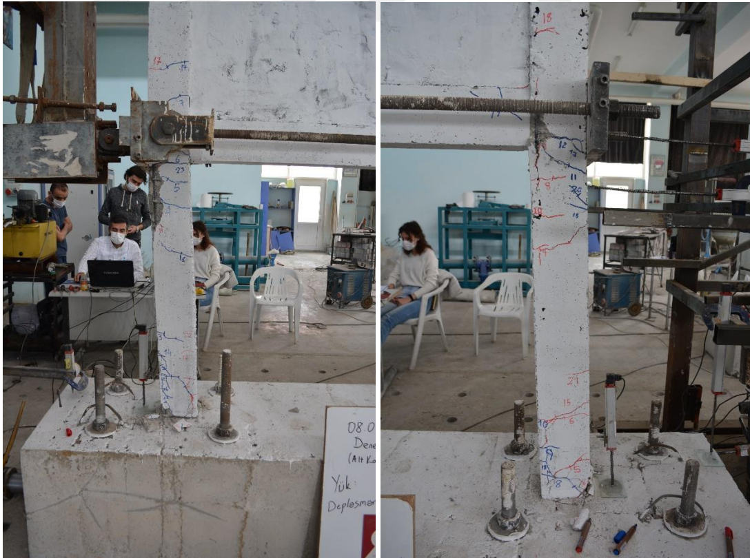
Şekil 4.9. R1 numunesinin -7 çevriminde oluşan çatlaklar
