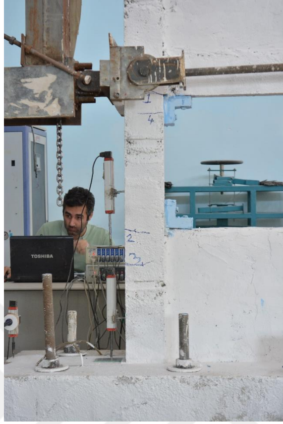
Şekil 4.98. R4-S1 numunesinin +2 çevriminde oluşan çatlaklar
