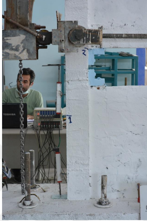
Şekil 4.78. R3-S1 numunesinin +1 çevriminde oluşan çatlaklar
