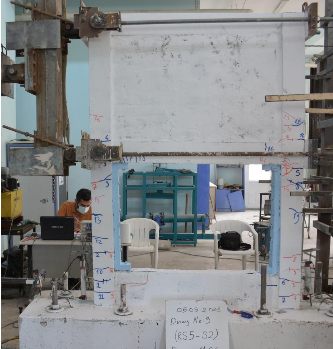
Şekil 4.165. R5-S2 numunesinin -4 çevriminde oluşan çatlaklar
