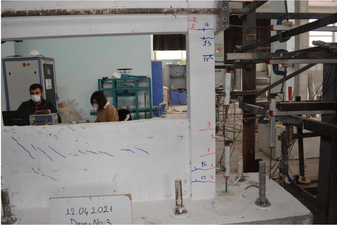
Şekil 4.52. R4 numunesinin -3 çevriminde oluşan çatlaklar
