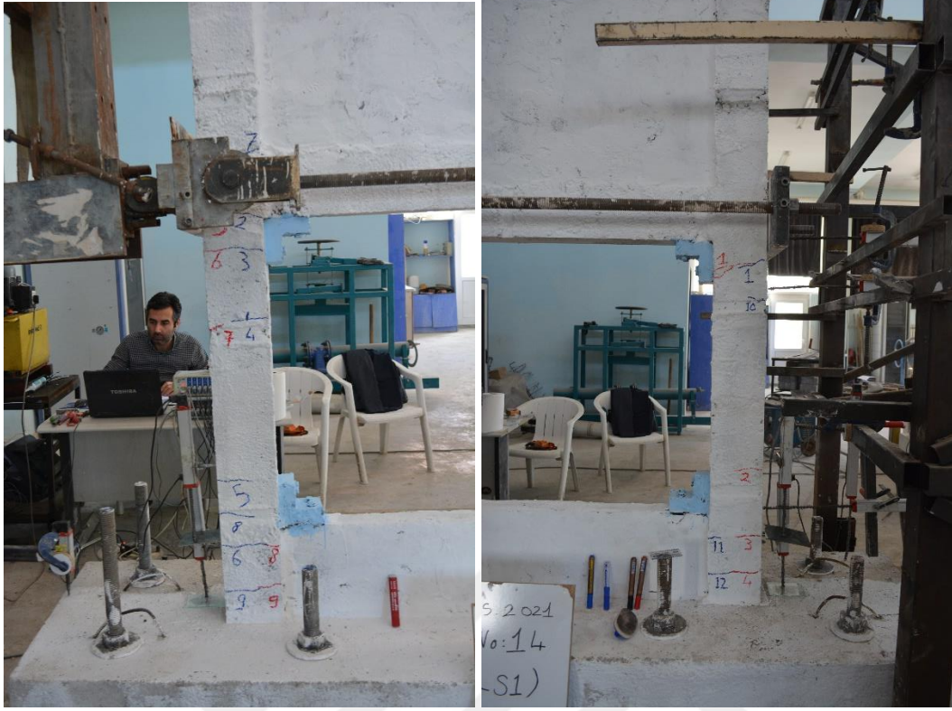
Şekil 4.114. R5-S1 numunesinin +3 çevriminde oluşan çatlaklar
