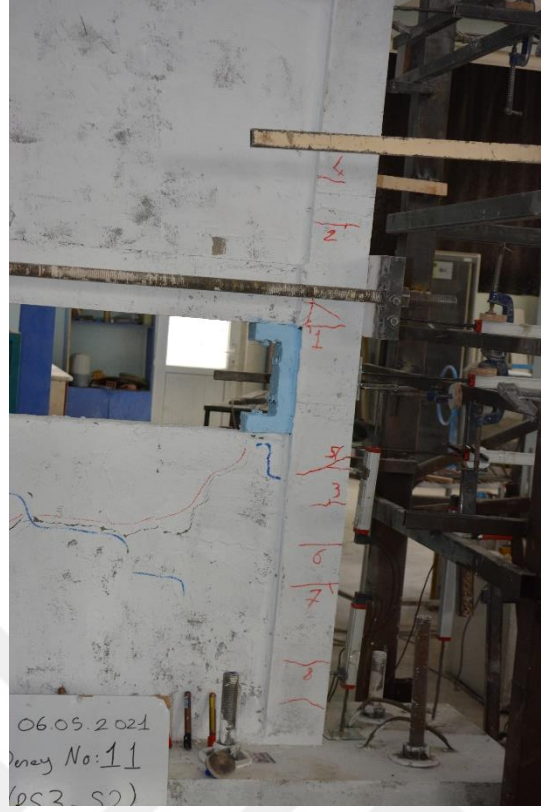
Şekil 4.130. R3-S2 numunesinin -3 çevriminde oluşan çatlaklar
