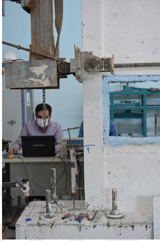
Şekil 4.190. R4-S3 numunesinin +1 çevriminde oluşan çatlaklar
