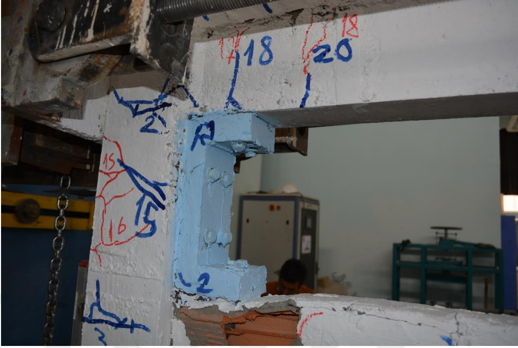
Şekil 4.134. R3-S2 numunesinin -5 çevriminde oluşan çatlaklar
