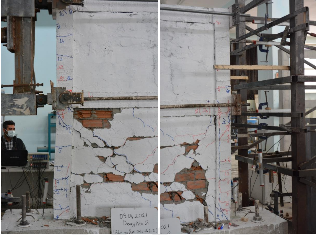
Şekil 4.26. R2 numunesinin -6 çevriminde oluşan çatlaklar
