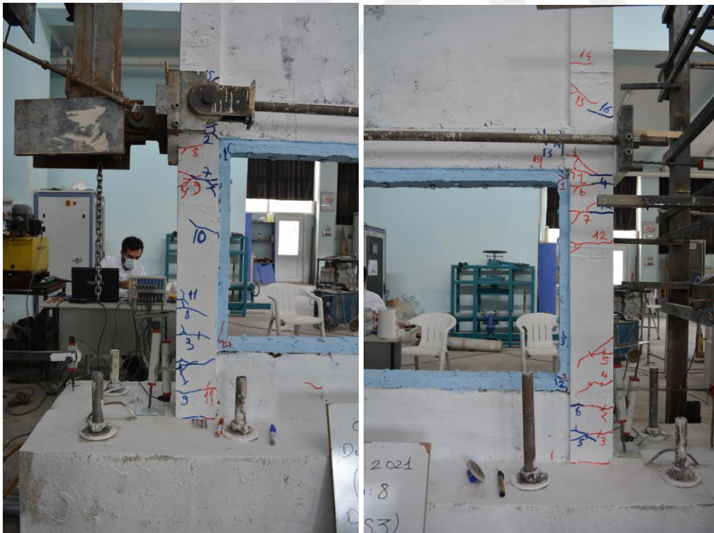
Şekil 4.213. R5-S3 numunesinin -4 çevriminde oluşan çatlaklar
