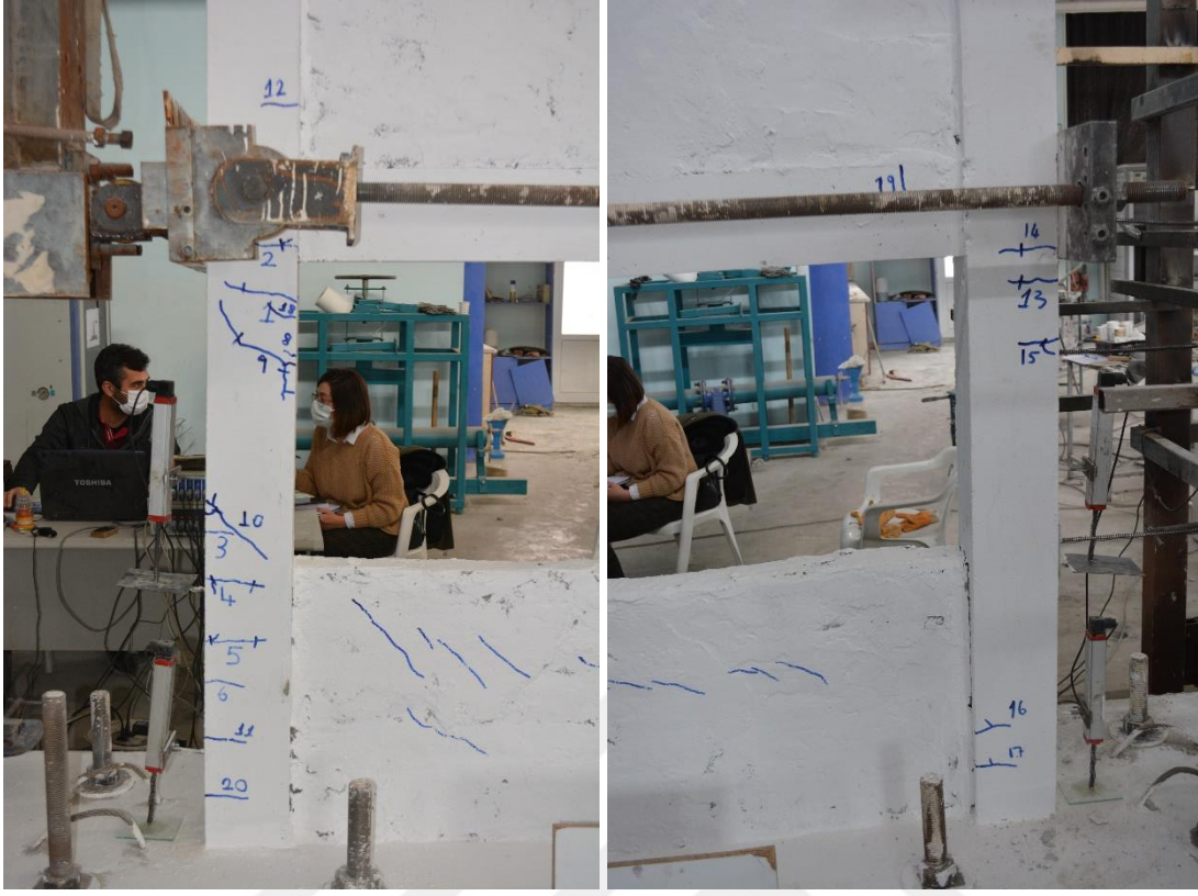
Şekil 4.51. R4 numunesinin +3 çevriminde oluşan çatlaklar
