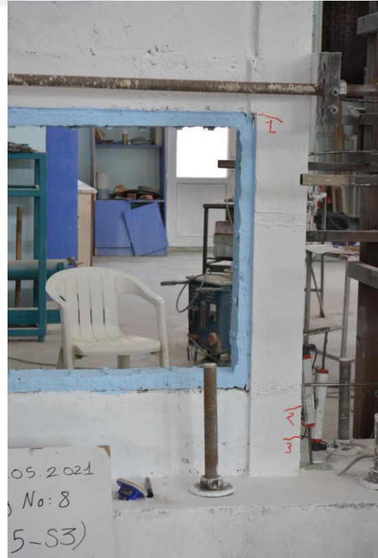
Şekil 4.207. R5-S3 numunesinin -1 çevriminde oluşan çatlaklar
