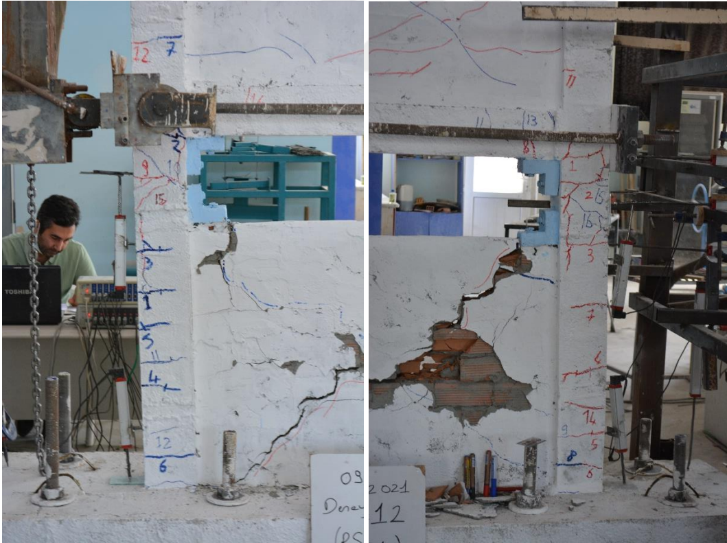
Şekil 4.86. R3-S1 numunesinin -5 çevriminde oluşan çatlaklar
