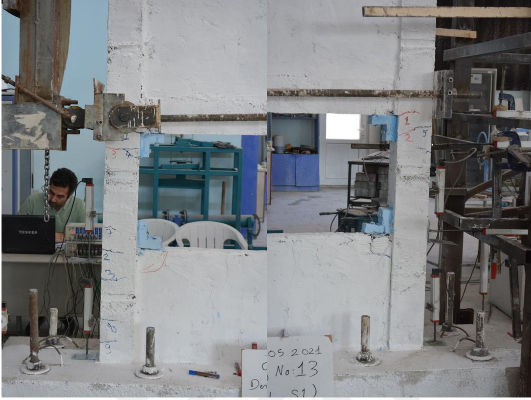
Şekil 4.100. R4-S1 numunesinin +3 çevriminde oluşan çatlaklar
