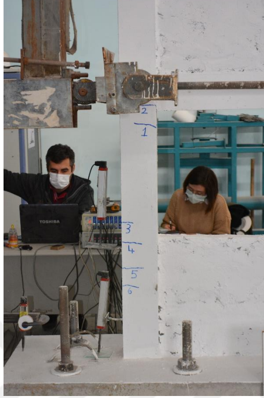
Şekil 4.49. R4 numunesinin +1 çevriminde oluşan çatlaklar
