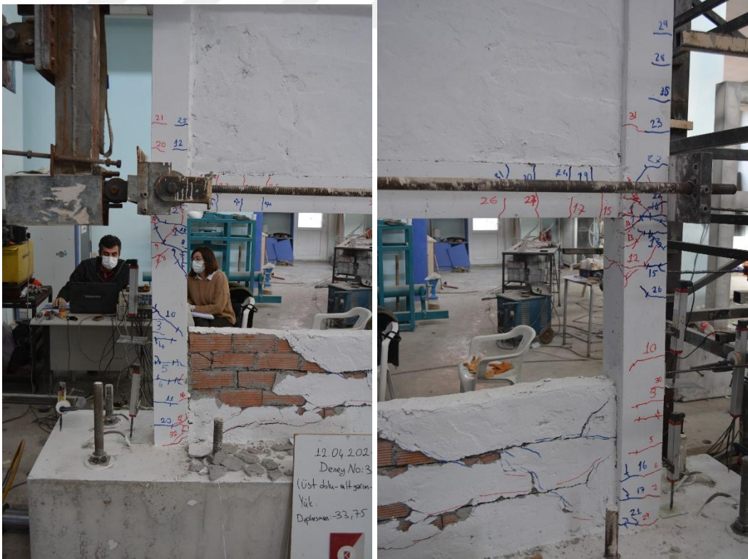
Şekil 4.58. R4 numunesinin -6 çevriminde oluşan çatlaklar
