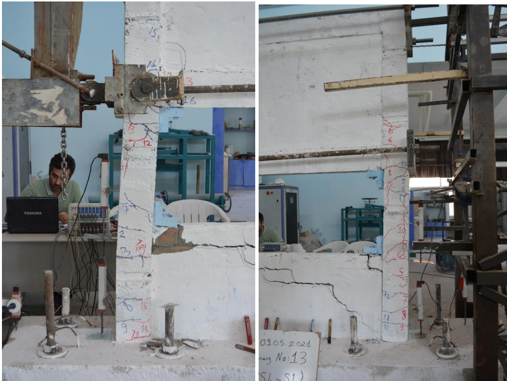
Şekil 4.105. R4-S1 numunesinin +6 çevriminde oluşan çatlaklar
