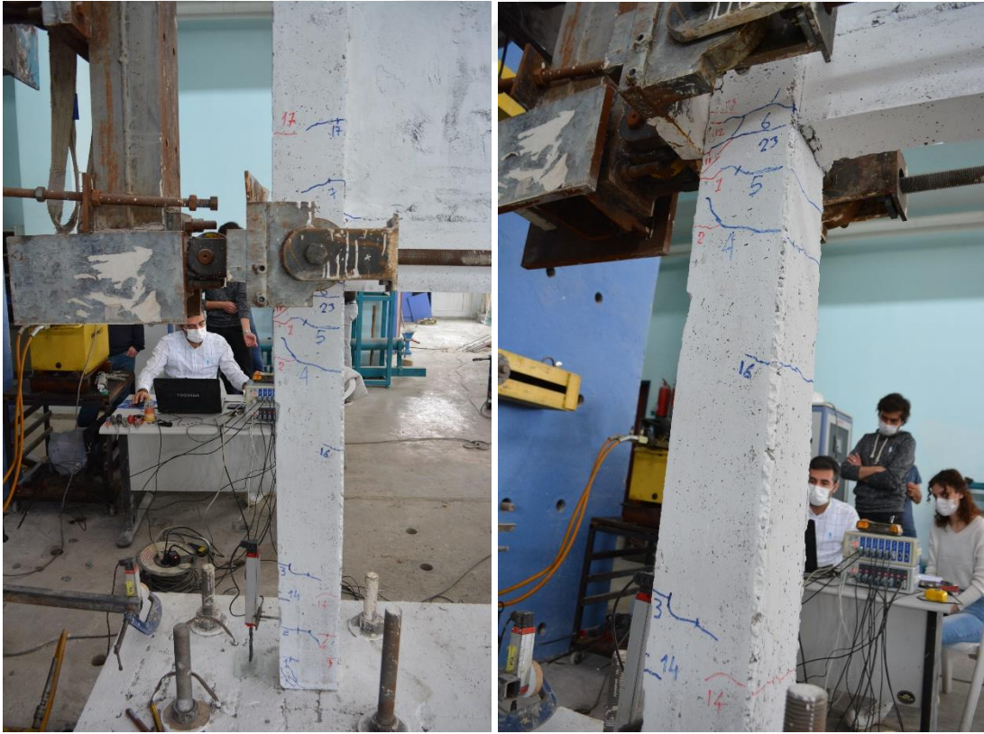
Şekil 4.5. R1 numunesinin +3 çevriminde oluşan çatlaklar
