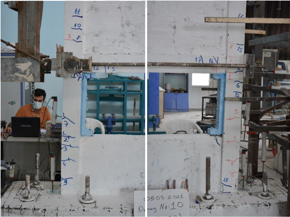
Şekil 4.148. R4-S2 numunesinin +4 çevriminde oluşan çatlaklar
