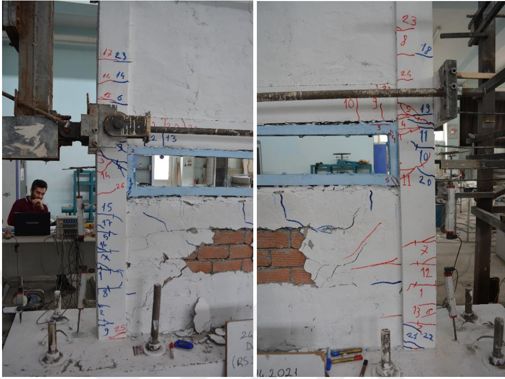
Şekil 4.182. R3-S3 numunesinin -5 çevriminde oluşan çatlaklar
