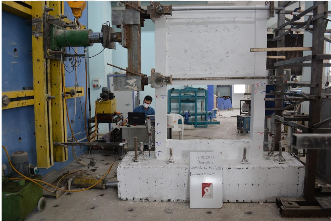
Şekil 4.68. R5 numunesinin +3 çevriminde oluşan çatlaklar
