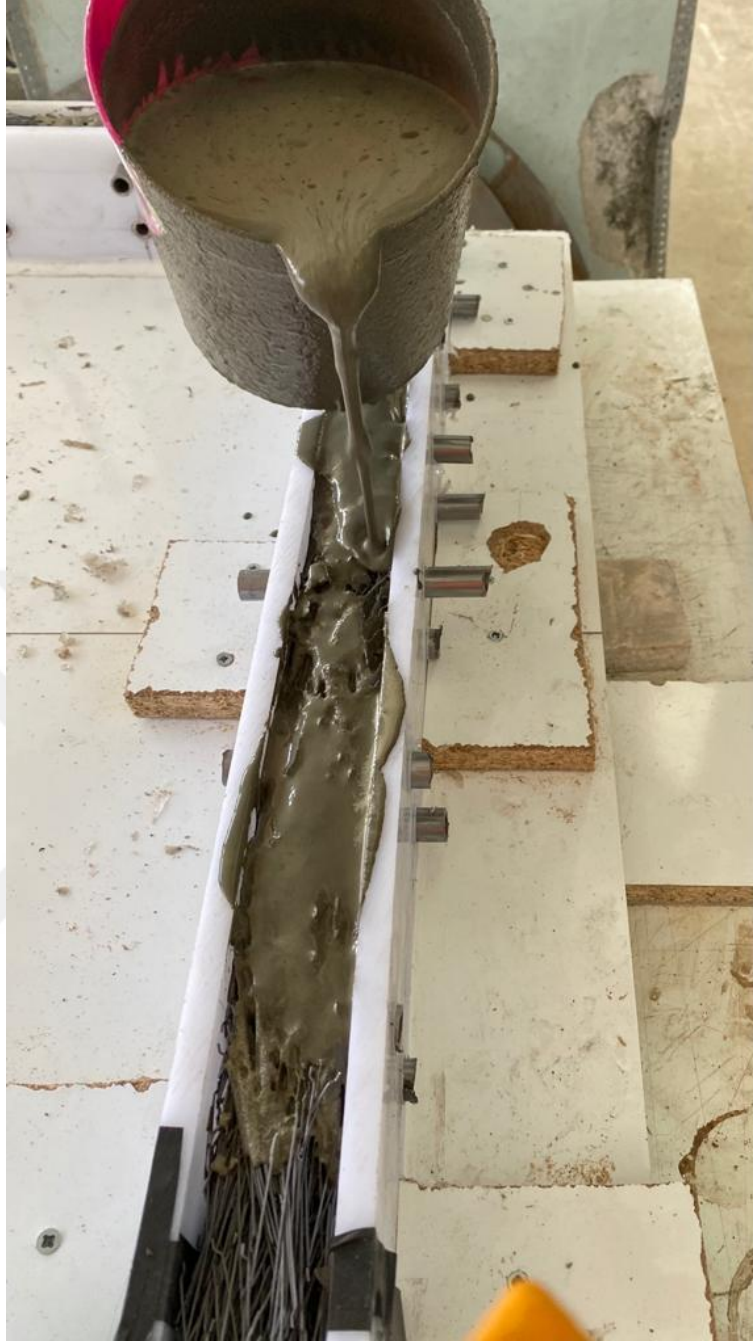
Şekil 3.20. (a) şerbet beton üretimi, (b) kalıplara yerleştirme işlemi
