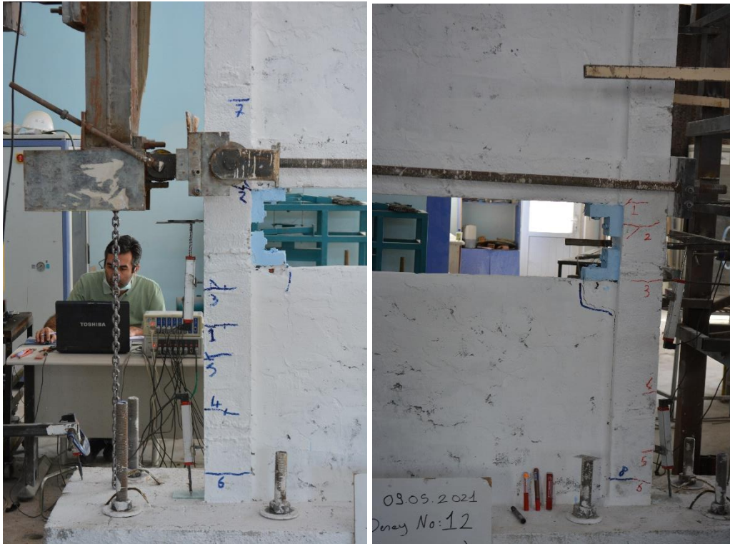
Şekil 4.81. R3-S1 numunesinin +3 çevriminde oluşan çatlaklar
