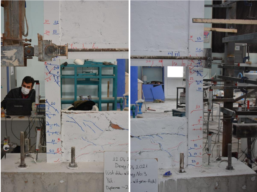
Şekil 4.56. R4 numunesinin -5 çevriminde oluşan çatlaklar
