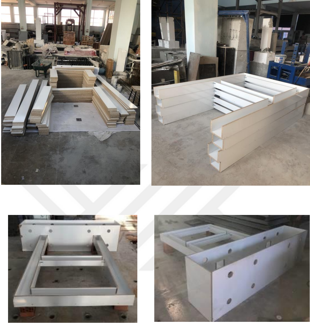
Şekil 3.8. Betonarme çerçeve kalıplarının hazırlanması
