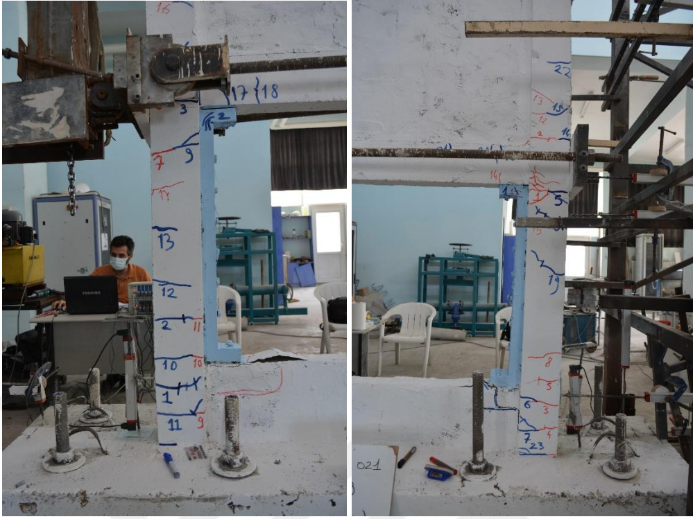
Şekil 4.166. R5-S2 numunesinin +5 çevriminde oluşan çatlaklar
