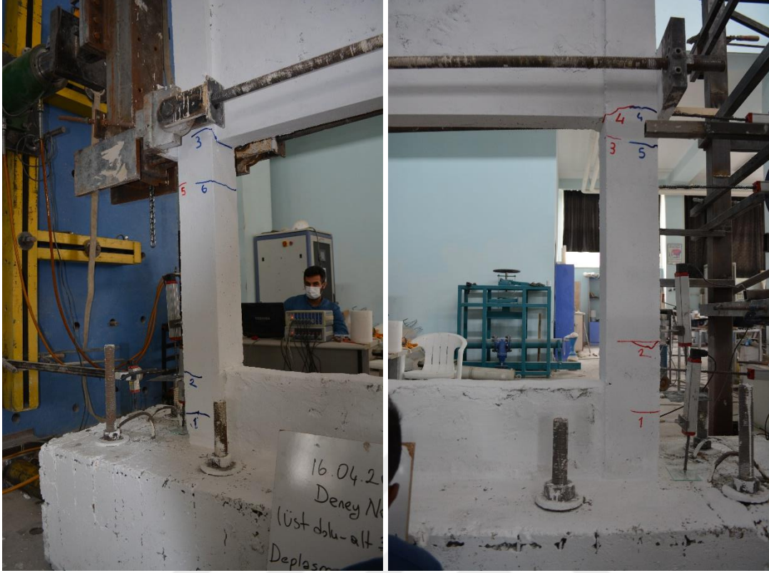
Şekil 4.67. R5 numunesinin -2 çevriminde oluşan çatlaklar
