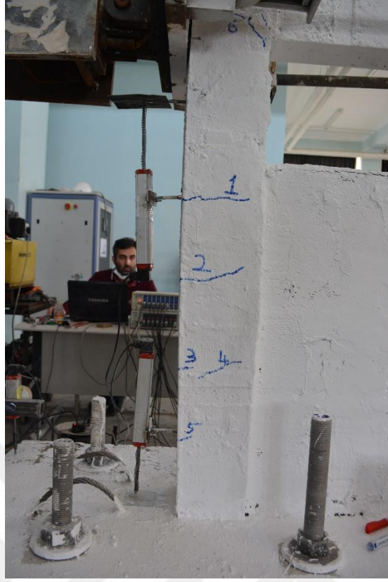
Şekil 4.33. R3 numunesinin +2 çevriminde oluşan çatlaklar
