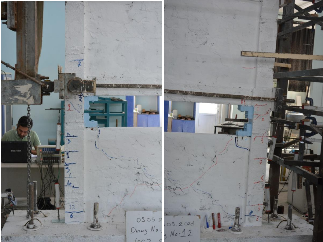
Şekil 4.83. R3-S1 numunesinin +4 çevriminde oluşan çatlaklar
