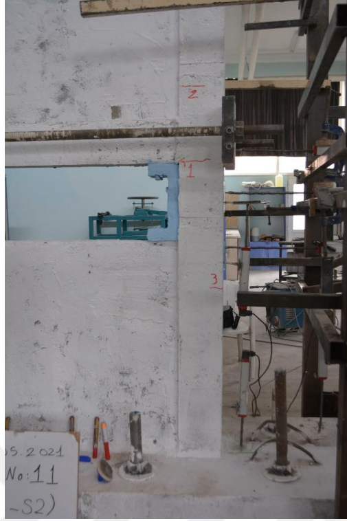
Şekil 4.128. R3-S2 numunesinin -2 çevriminde oluşan çatlaklar
