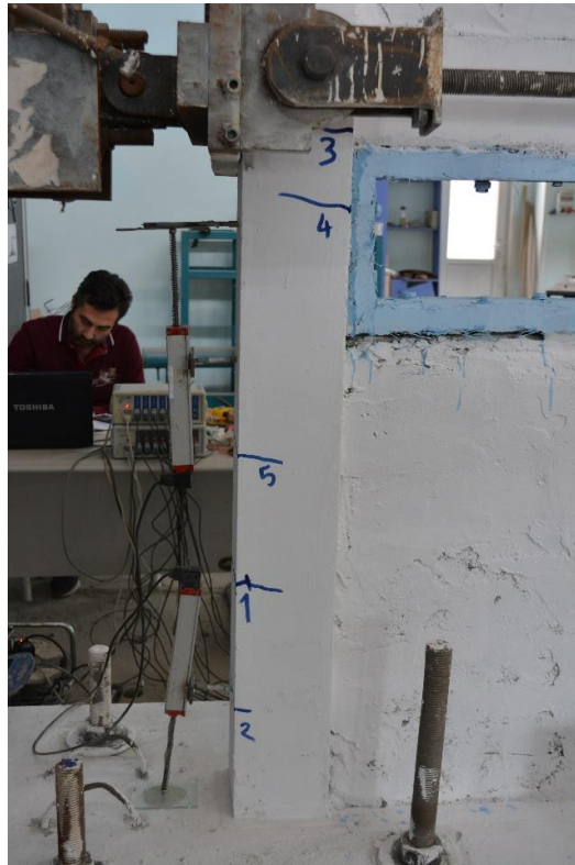
Şekil 4.175. R3-S3 numunesinin +2 çevriminde oluşan çatlaklar
