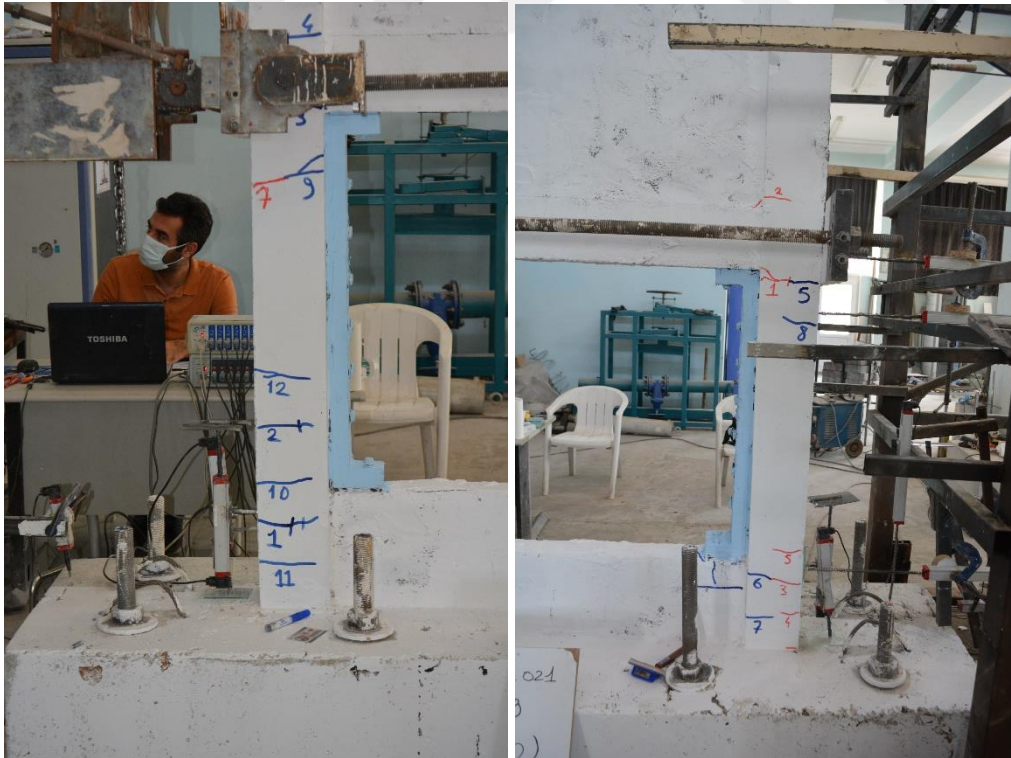
Şekil 4.162. R5-S2 numunesinin +3 çevriminde oluşan çatlaklar
