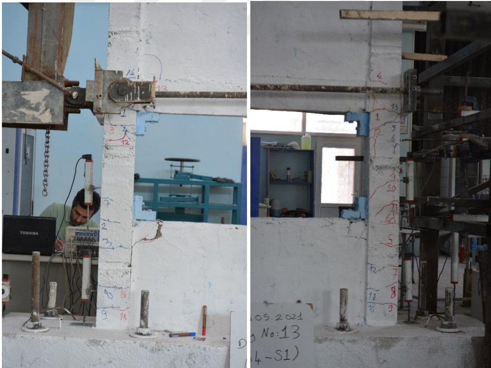
Şekil 4.103. R4-S1 numunesinin -4 çevriminde oluşan çatlaklar
