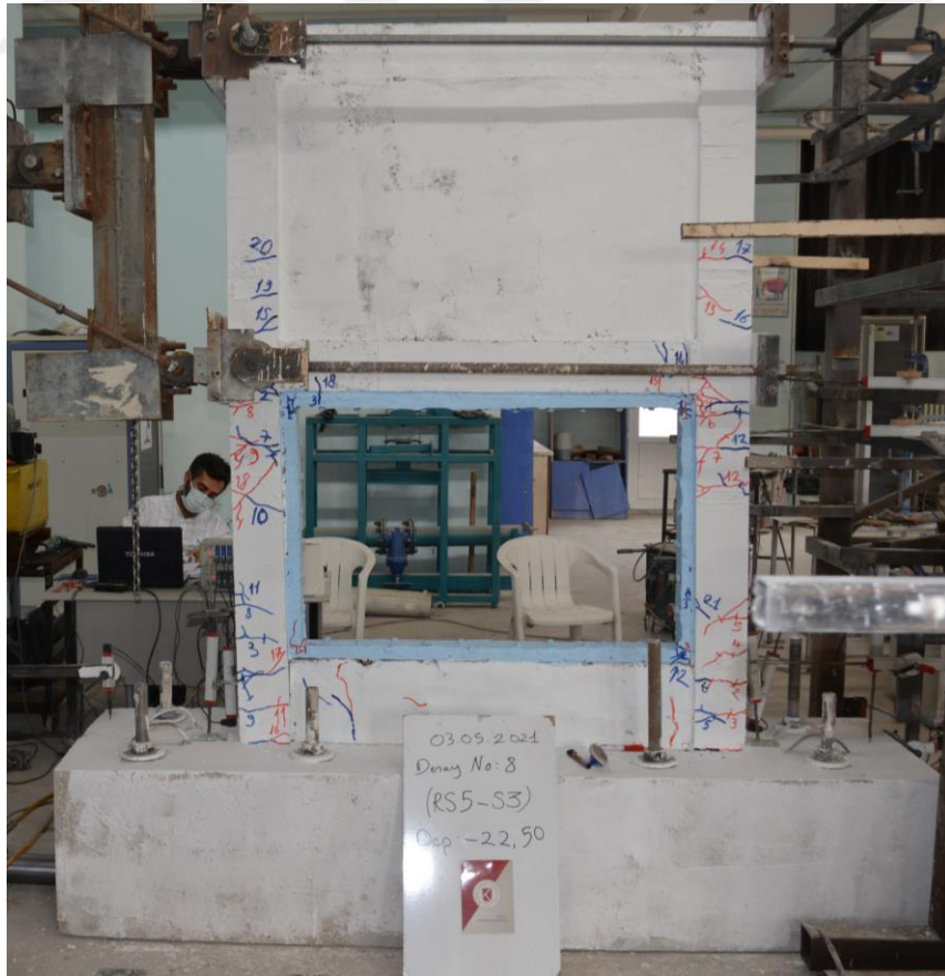
Şekil 4.215. R5-S3 numunesinin -5 çevriminde oluşan çatlaklar
