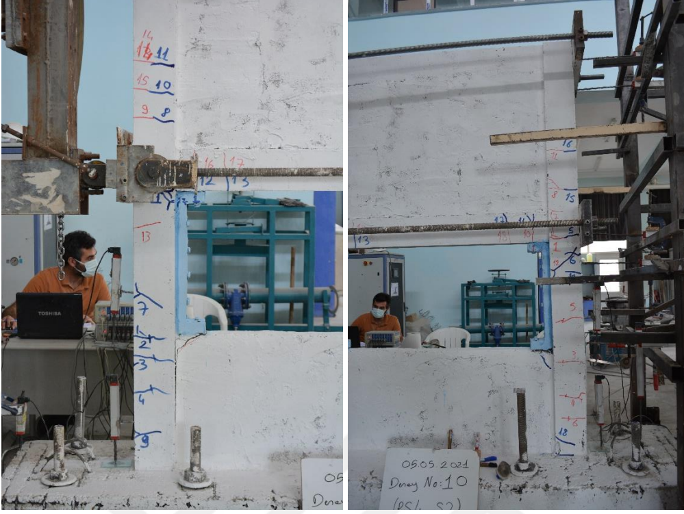
Şekil 4.149. R4-S2 numunesinin -4 çevriminde oluşan çatlaklar
