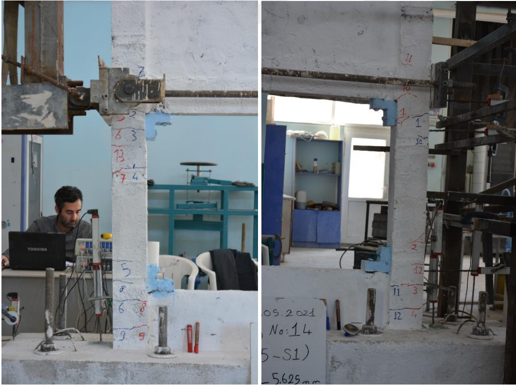
Şekil 4.115. R5-S1 numunesinin -3 çevriminde oluşan çatlaklar
