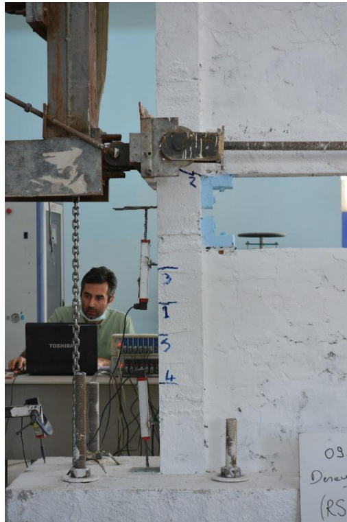
Şekil 4.79. R3-S1 numunesinin +2 çevriminde oluşan çatlaklar
