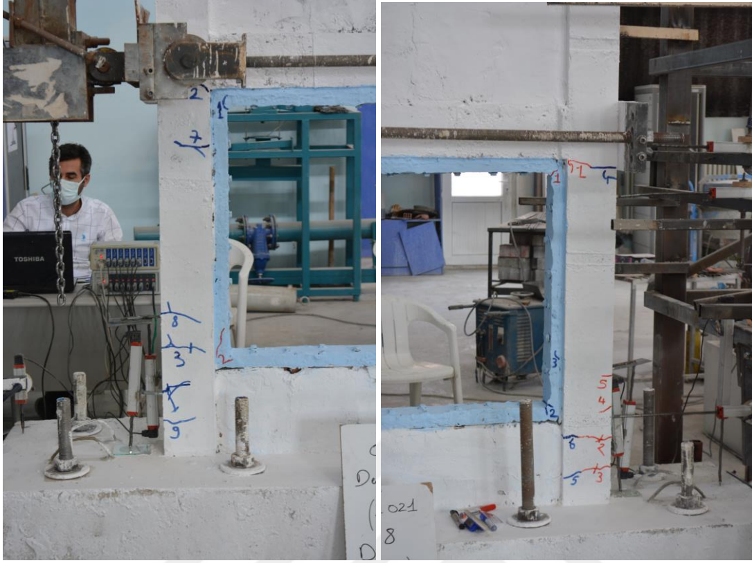
Şekil 4.210. R5-S3 numunesinin +3 çevriminde oluşan çatlaklar
