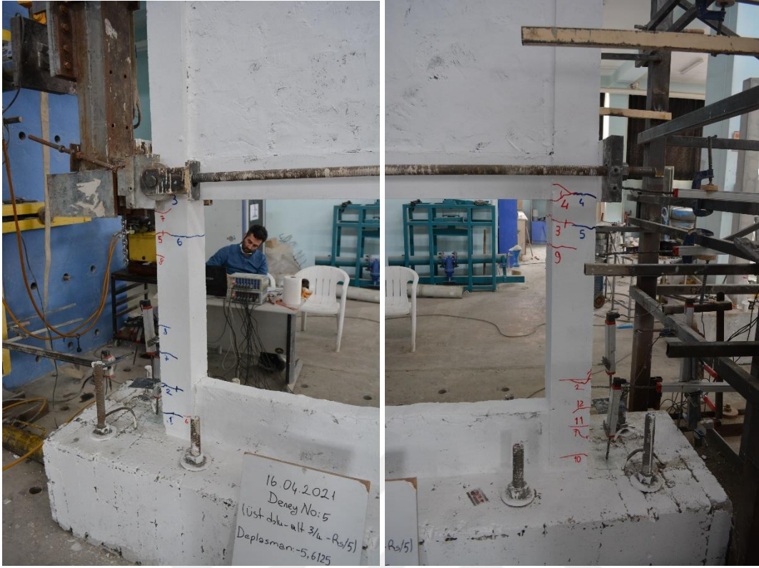
Şekil 4.68. R5 numunesinin -3 çevriminde oluşan çatlaklar
