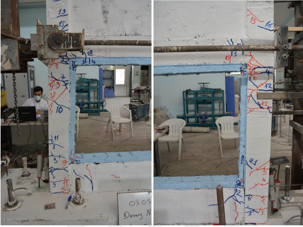
Şekil 4.216. R5-S3 numunesinin +6 çevriminde oluşan çatlaklar
