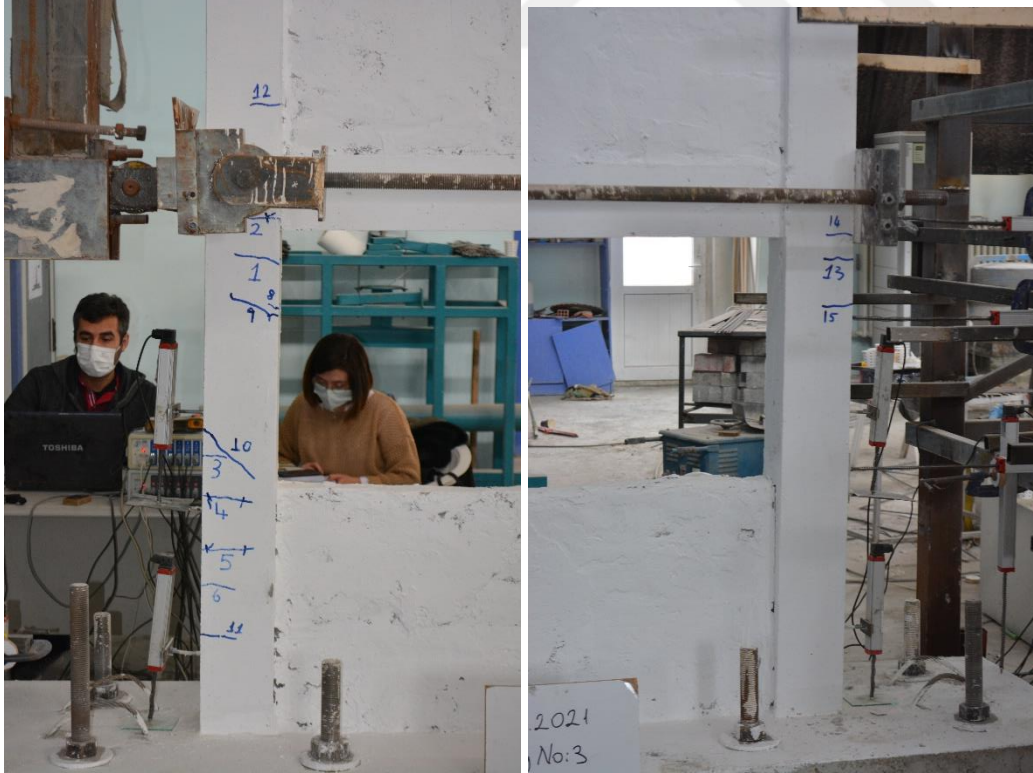
Şekil 4.50. R4 numunesinin +2 çevriminde oluşan çatlaklar
