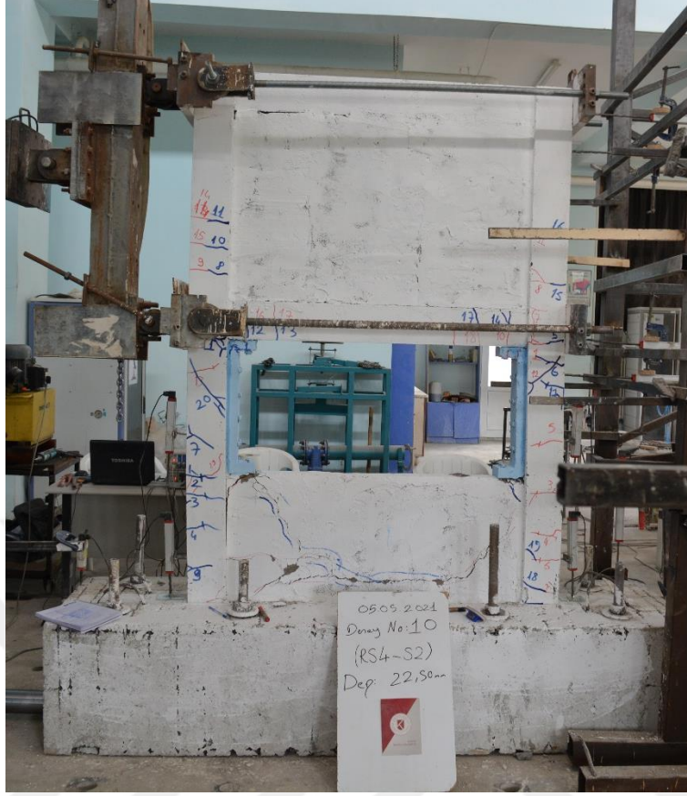
Şekil 4.151. R4-S2 numunesinin -5 çevriminde oluşan çatlaklar
