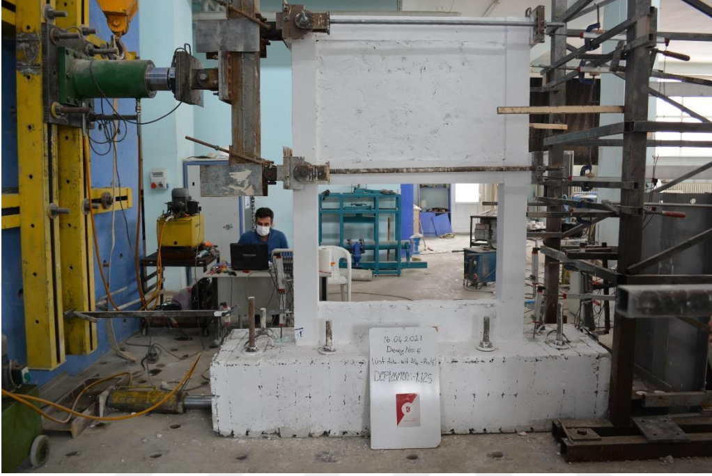
Şekil 4.65. R5 numunesinin +1 çevriminde oluşan çatlaklar
