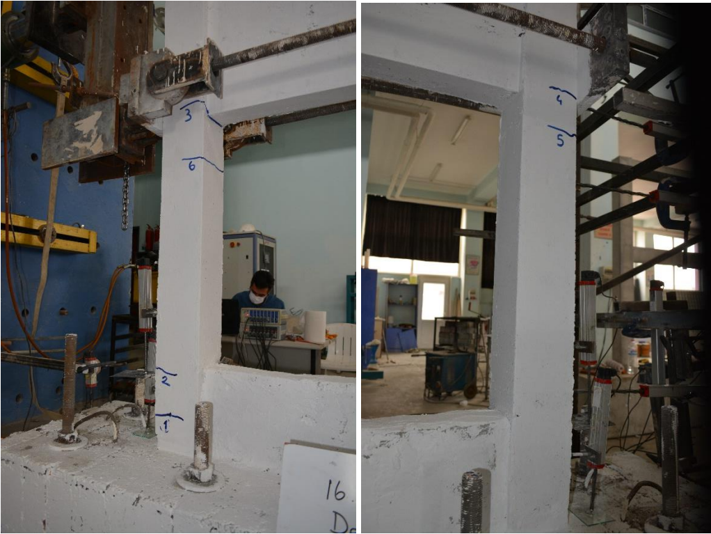
Şekil 4.66. R5 numunesinin +2 çevriminde oluşan çatlaklar
