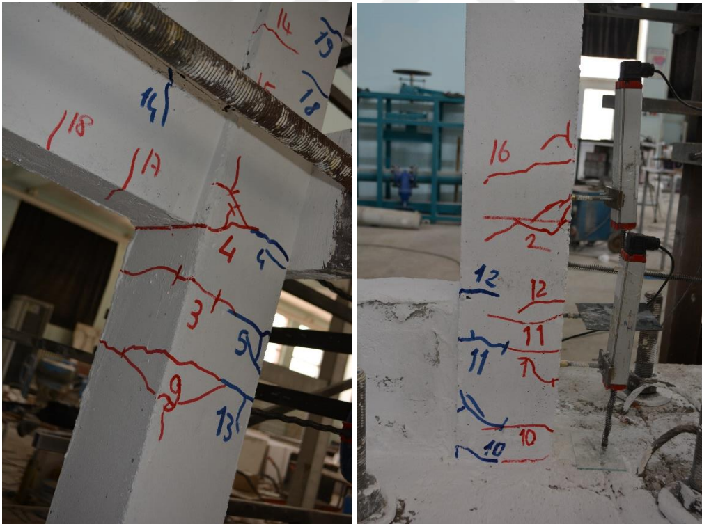
Şekil 4.70. R5 numunesinin -4 çevriminde oluşan çatlaklar
