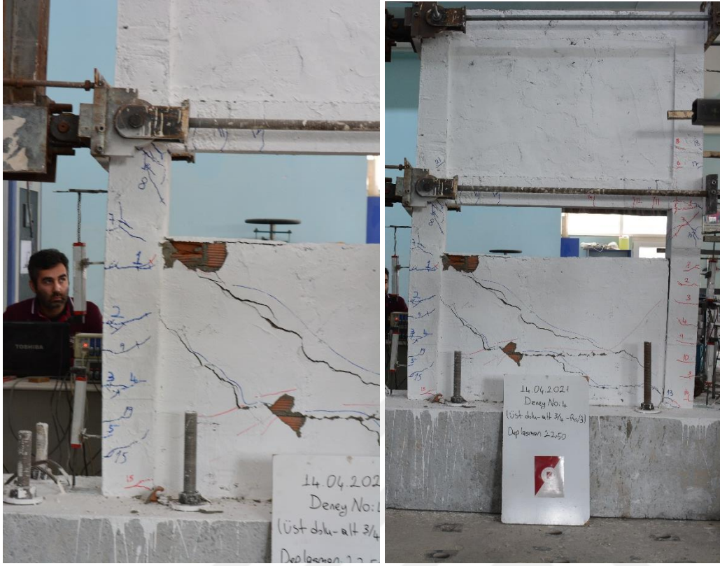
Şekil 4.39. R3 numunesinin +5 çevriminde oluşan çatlaklar
