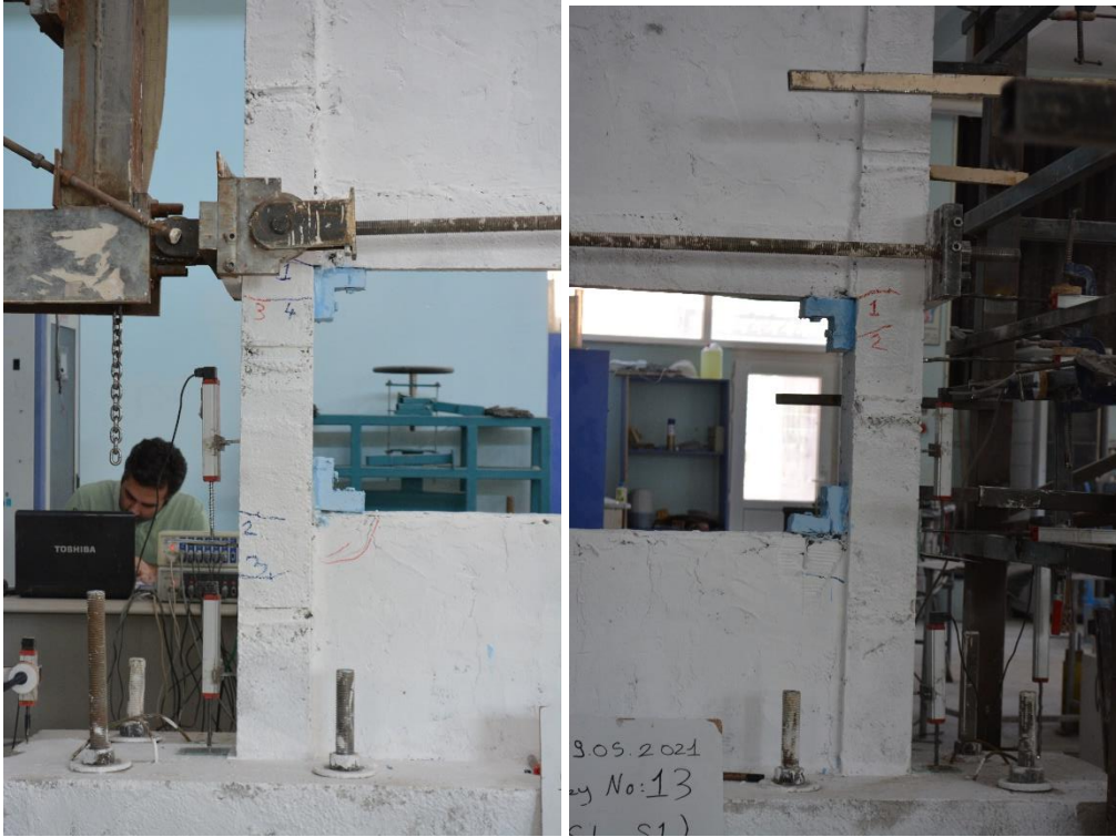
Şekil 4.99. R4-S1 numunesinin -2 çevriminde oluşan çatlaklar
