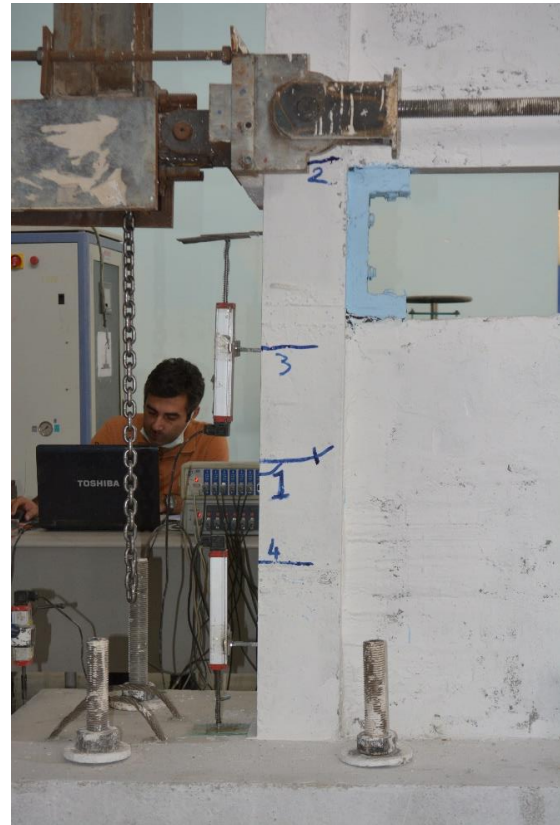
Şekil 4.127. R3-S2 numunesinin +2 çevriminde oluşan çatlaklar
