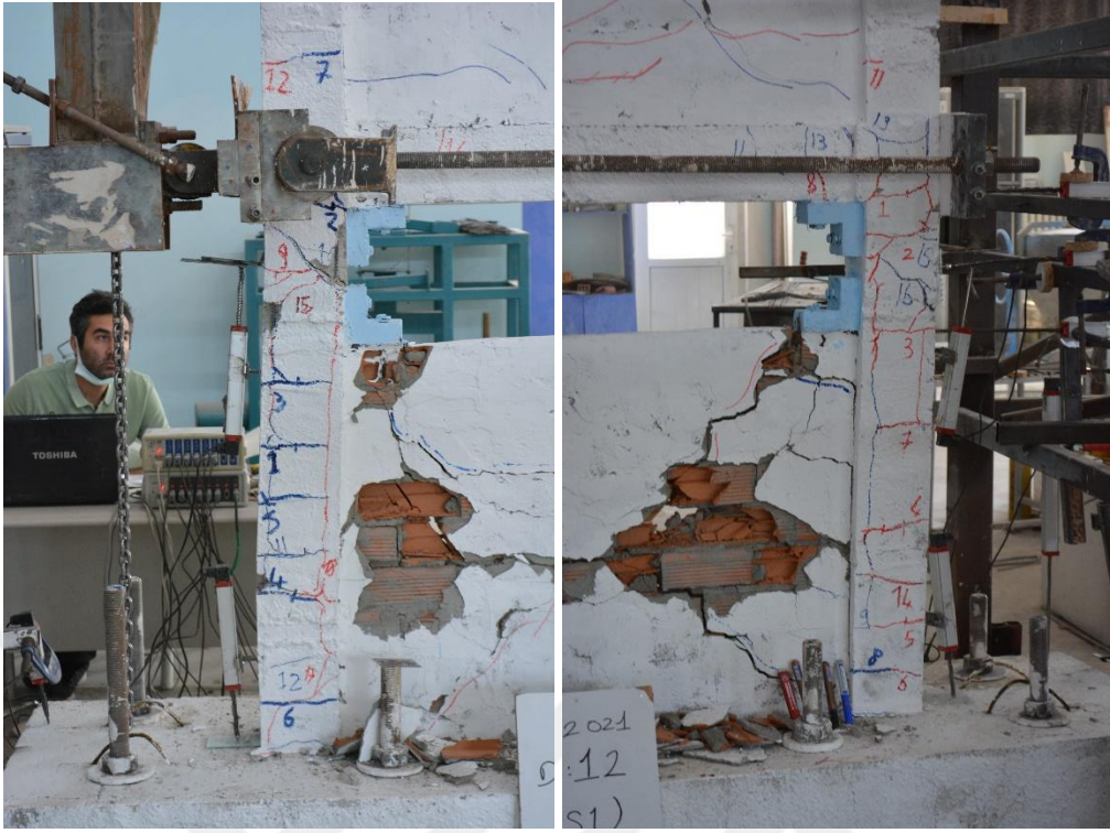
Şekil 4.89. R3-S1 numunesinin +7 çevriminde oluşan çatlaklar
