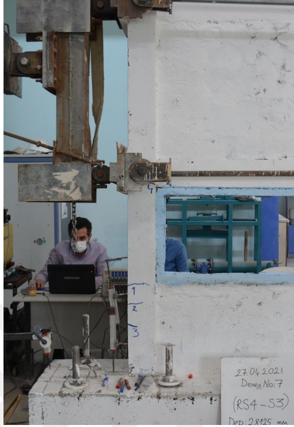
Şekil 4.192. R4-S3 numunesinin +2 çevriminde oluşan çatlaklar
