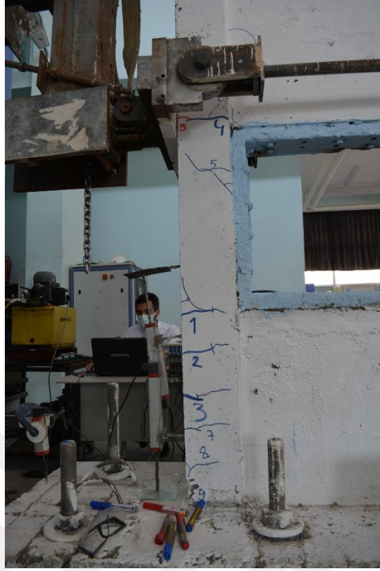
Şekil 4.194. R4-S3 numunesinin +3 çevriminde oluşan çatlaklar
