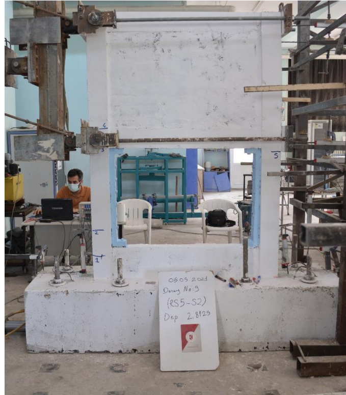
Şekil 4.160. R5-S2 numunesinin +2 çevriminde oluşan çatlaklar
