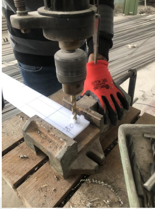
Şekil 3.17. SIFCON panel kalıbı ankraj deliklerinin açılması
