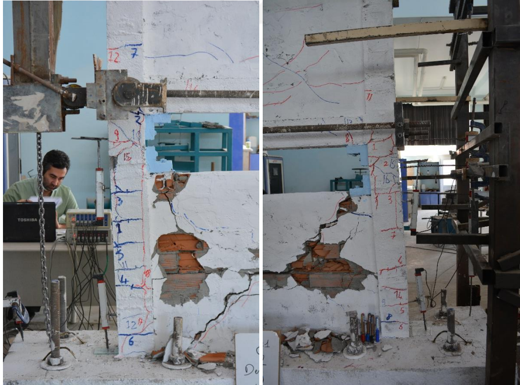
Şekil 4.88. R3-S1 numunesinin -6 çevriminde oluşan çatlaklar
