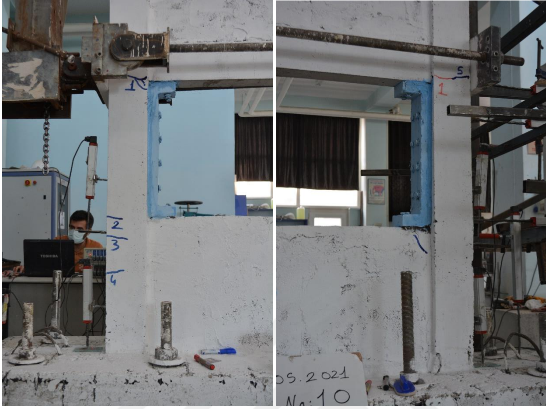
Şekil 4.144. R4-S2 numunesinin +2 çevriminde oluşan çatlaklar
