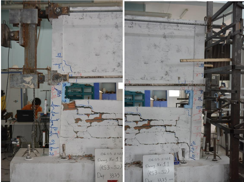
Şekil 4.135. R3-S2 numunesinin +6 çevriminde oluşan çatlaklar
