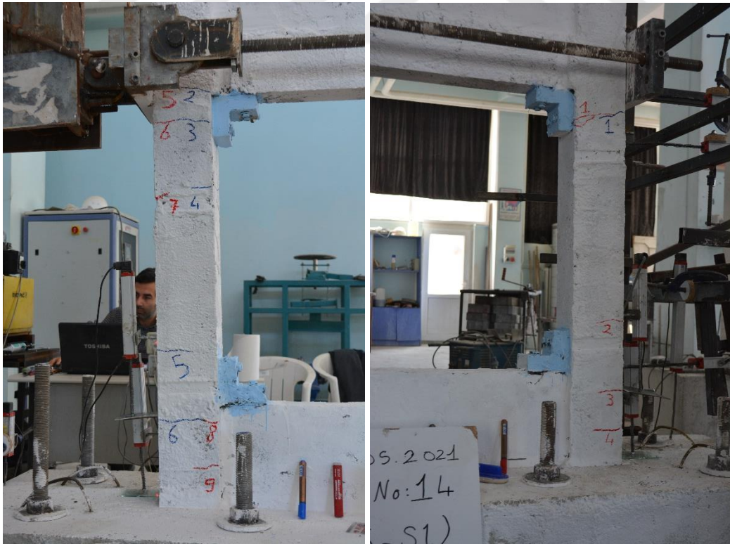
Şekil 4.113. R5-S1 numunesinin -2 çevriminde oluşan çatlaklar
