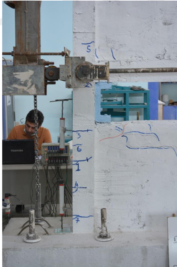
Şekil 4.129. R3-S2 numunesinin +3 çevriminde oluşan çatlaklar
