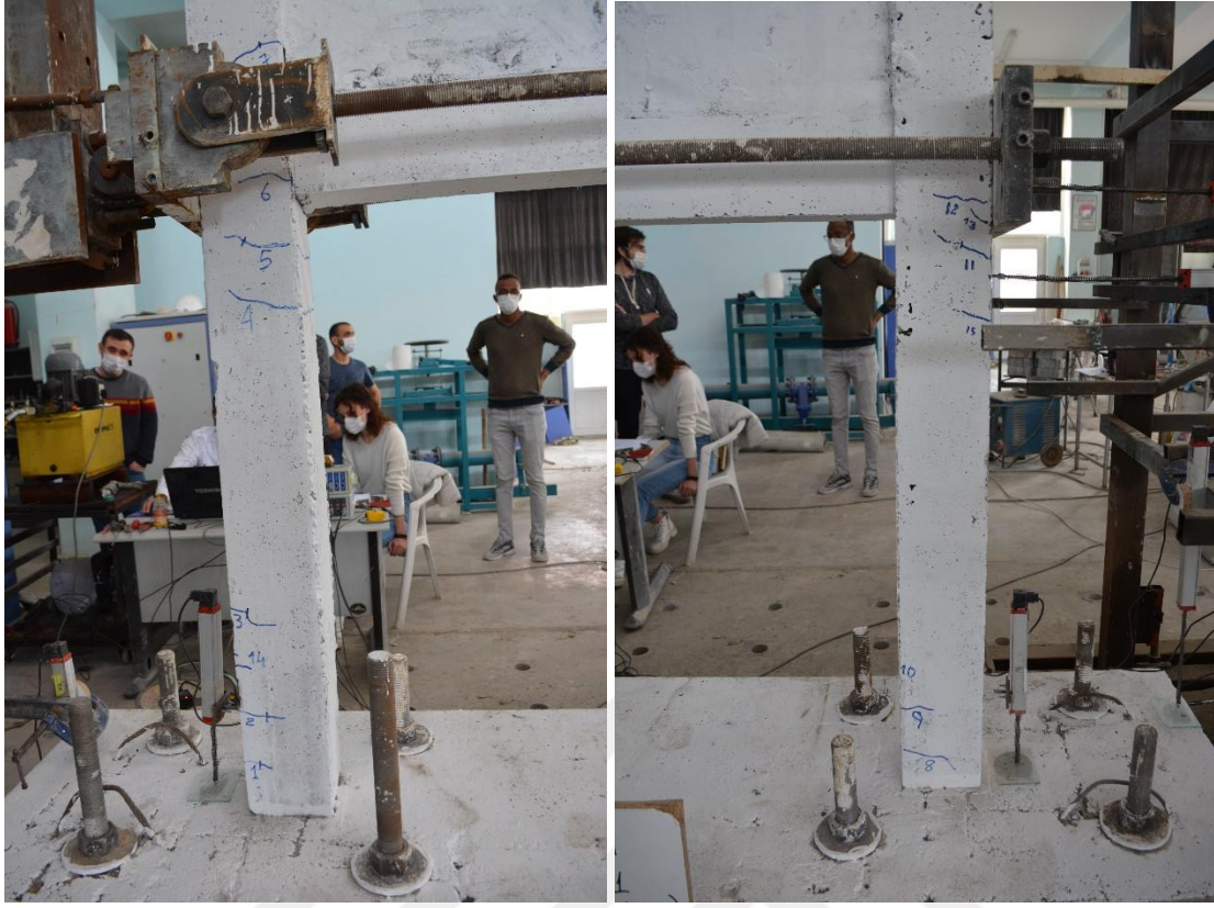
Şekil 4.3. R1 numunesinin +2 çevriminde oluşan çatlaklar
