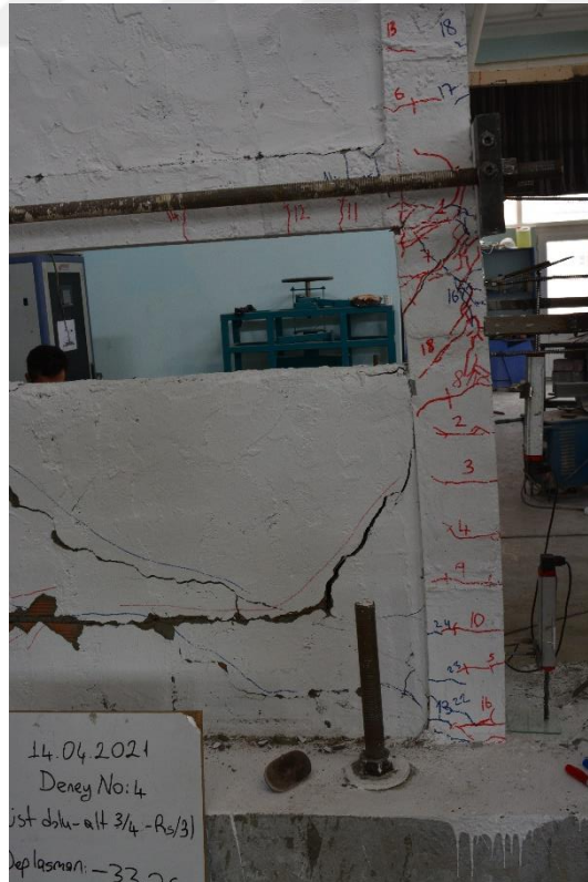
Şekil 4.42. R3 numunesinin -6 çevriminde oluşan çatlaklar
