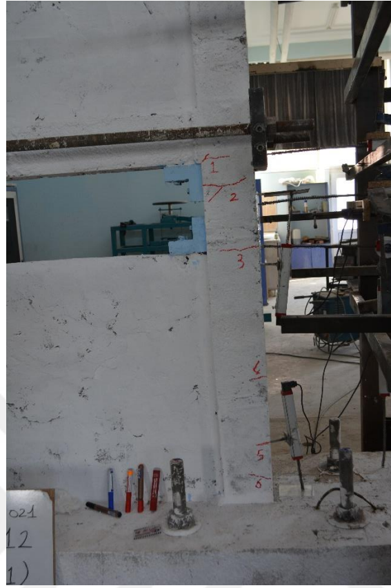
Şekil 4.80. R3-S1 numunesinin -2 çevriminde oluşan çatlaklar
