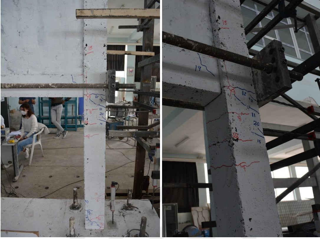
Şekil 4.6. R1 numunesinin -3 çevriminde oluşan çatlaklar
