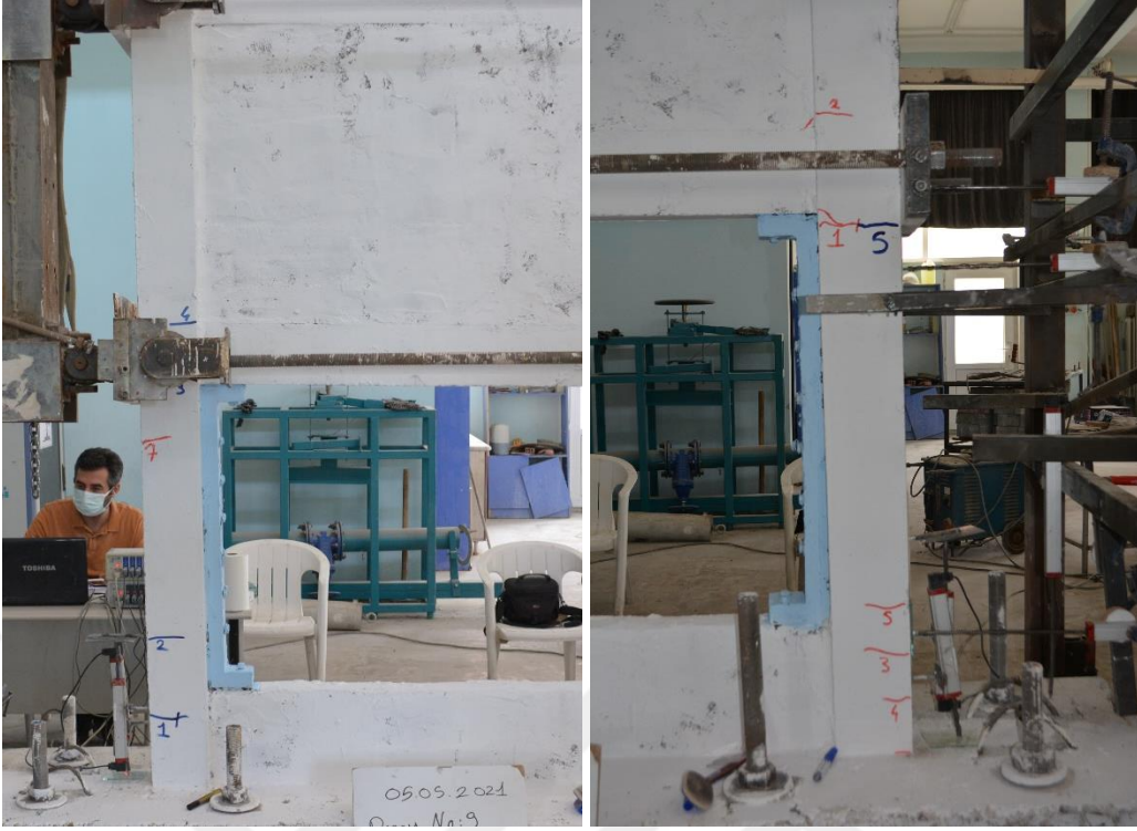
Şekil 4.161. R5-S2 numunesinin -2 çevriminde oluşan çatlaklar
