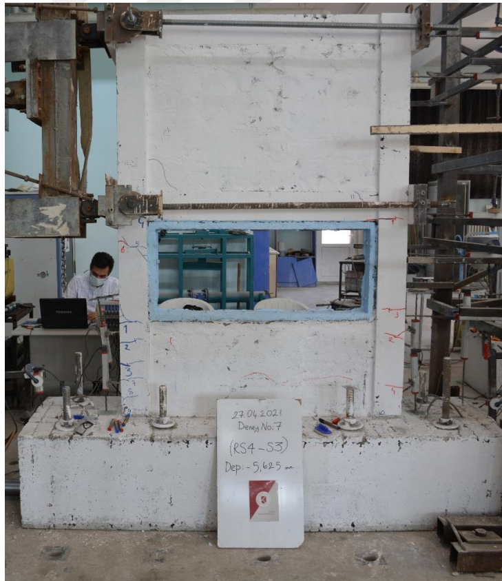
Şekil 4.195. R4-S3 numunesinin -3 çevriminde oluşan çatlaklar
