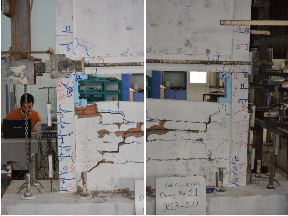
Şekil 4.136. R3-S2 numunesinin -6 çevriminde oluşan çatlaklar
