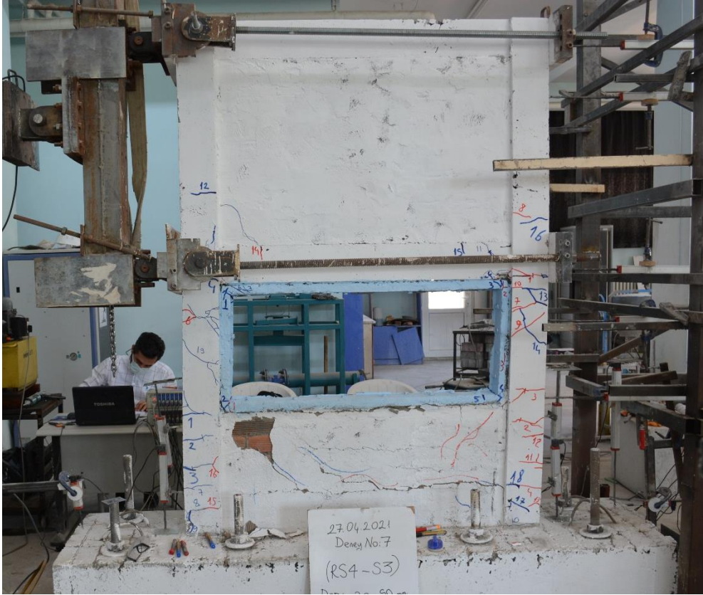
Şekil 4.197. R4-S3 numunesinin -4 çevriminde oluşan çatlaklar
