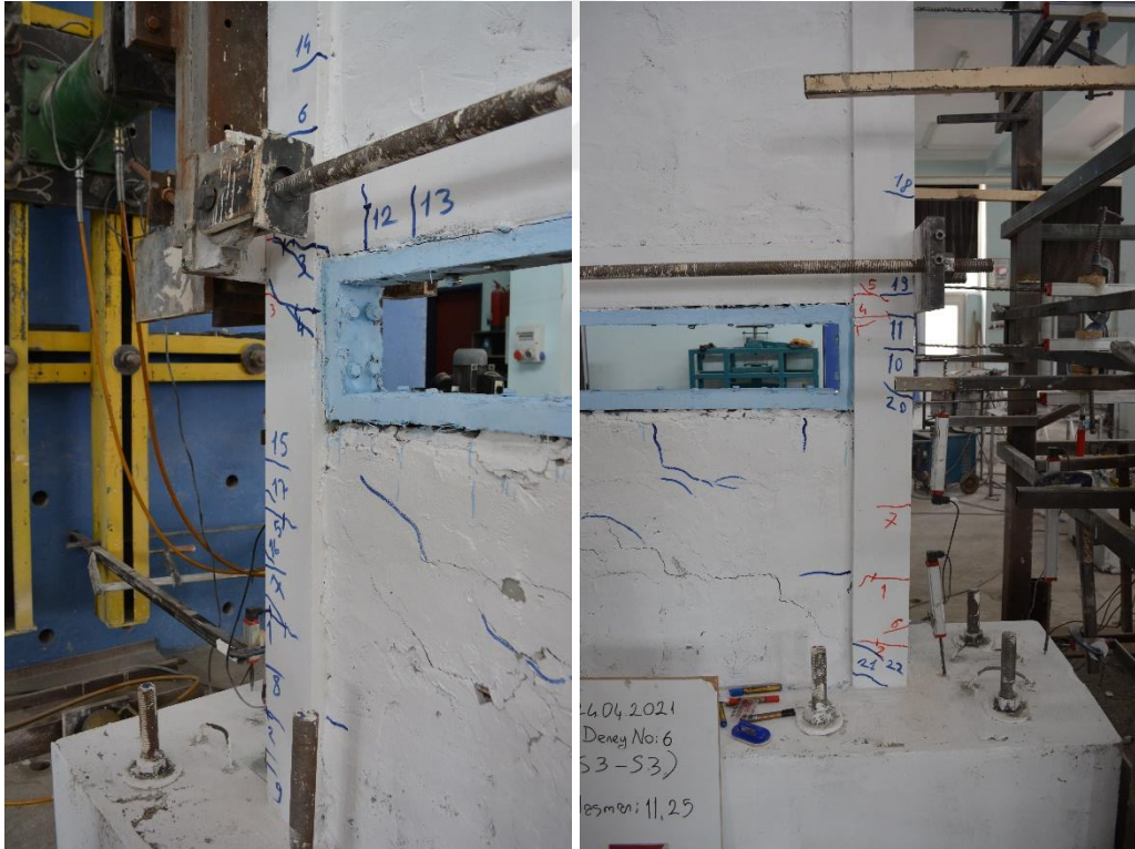
Şekil 4.179. R3-S3 numunesinin +4 çevriminde oluşan çatlaklar
