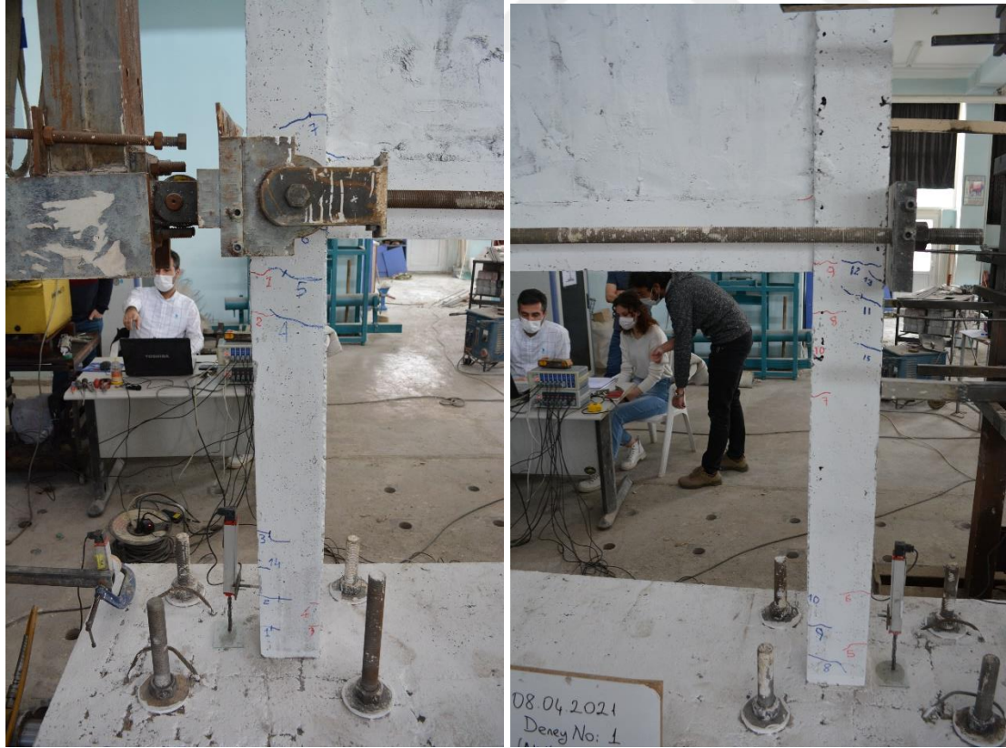
Şekil 4.4. R1 numunesinin -2 çevriminde oluşan çatlaklar
