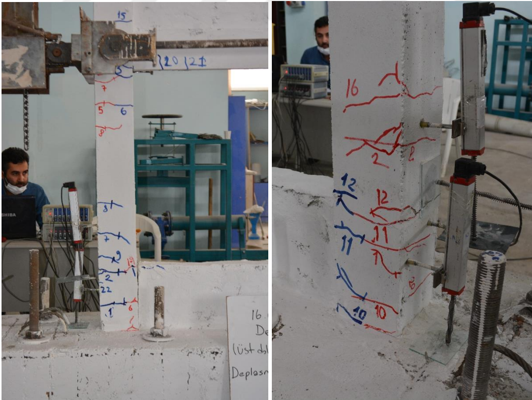
Şekil 4.72. R5 numunesinin -5 çevriminde oluşan çatlaklar
