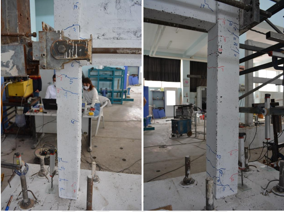
Şekil 4.5. R1 numunesinin +3 çevriminde oluşan çatlaklar
