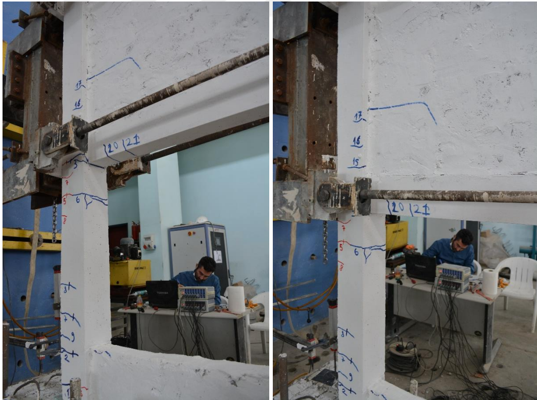
Şekil 4.68. R5 numunesinin -3 çevriminde oluşan çatlaklar
