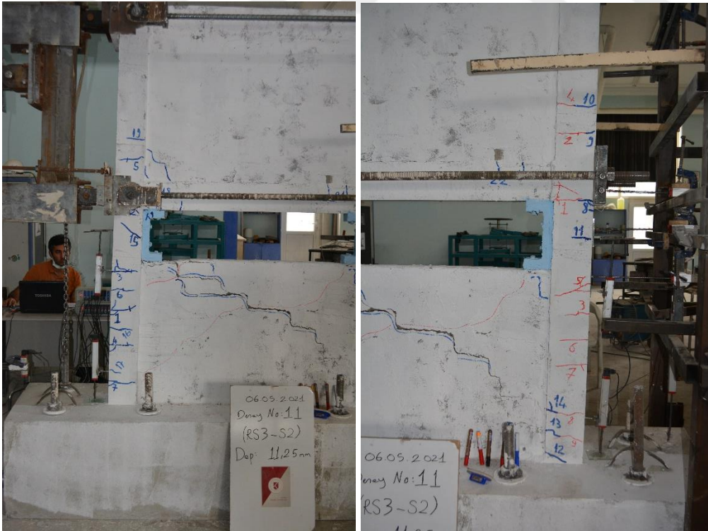
Şekil 4.131. R3-S2 numunesinin +4 çevriminde oluşan çatlaklar
