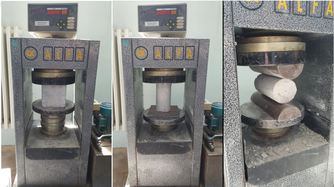
Şekil 3.65. Üniversite laboratuvarındaki basınç ve yarmada çekme deneyleri
