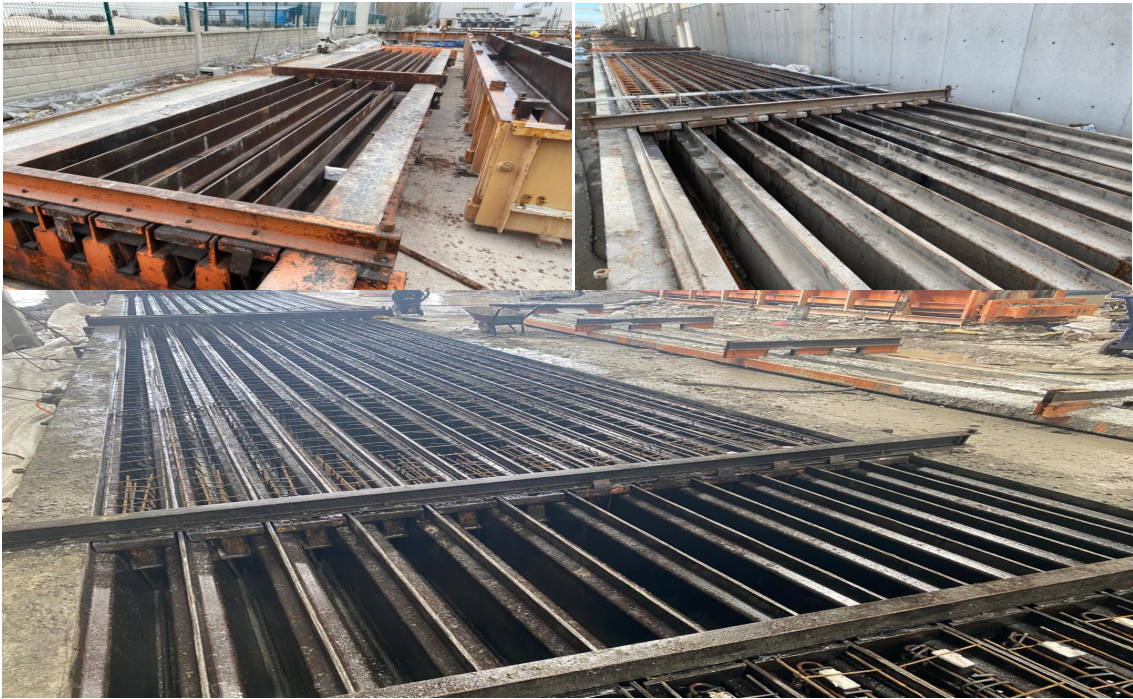
Şekil 3.10. 6'lı, 8'li ve 12'li yatak kapasiteli aşık kiriş kalıpları
