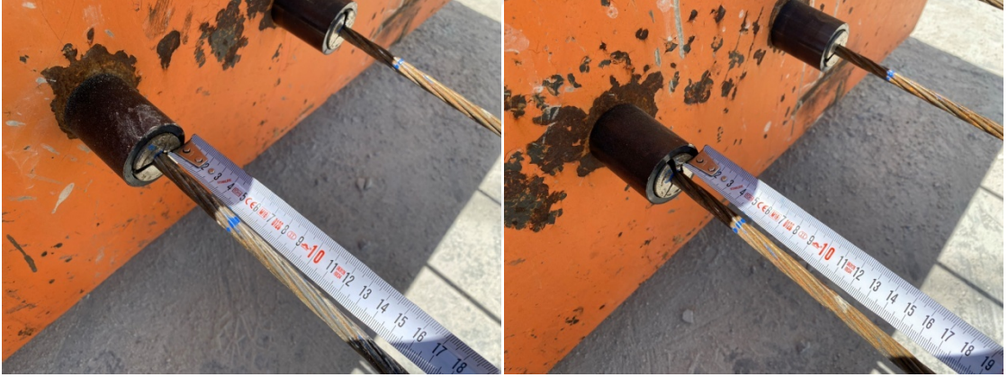
Şekil 3.24. Sırasıyla PP-3 ve PP-2 numaralı aşıkların öngerme uzama değerleri ölçümü
