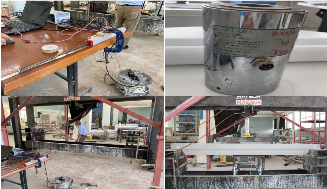
Şekil 3.60. Deneylerde kullanılacak elemanların kalibrasyonu ve ilk kirişin düzeneğe yerleştirilmesi
