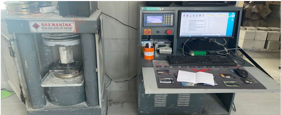
Şekil 3.66. Üretim tesisinde yapılan basınç deneyi
