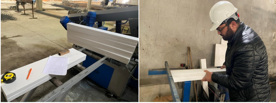
Şekil 3.12. Çalışmada kullanılan straforların farklı boyutlara göre kesilmesi
