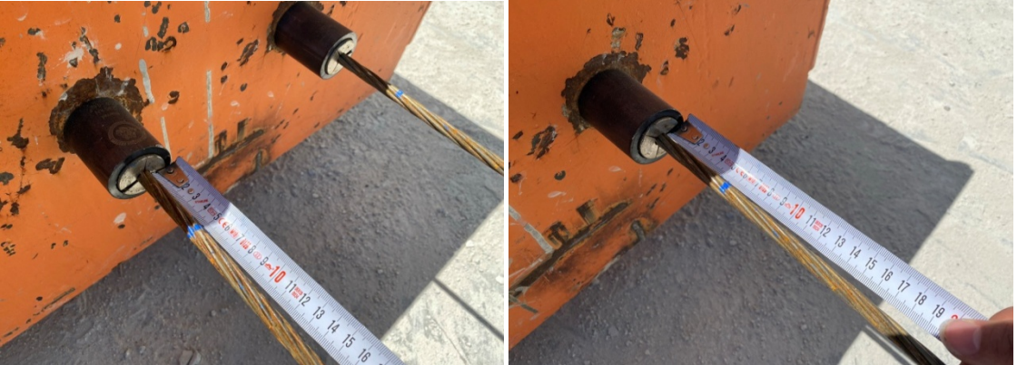
Şekil 3.25. Sırasıyla PP-1 ve PP-0 numaralı aşıkların öngerme uzama değerleri ölçümü
