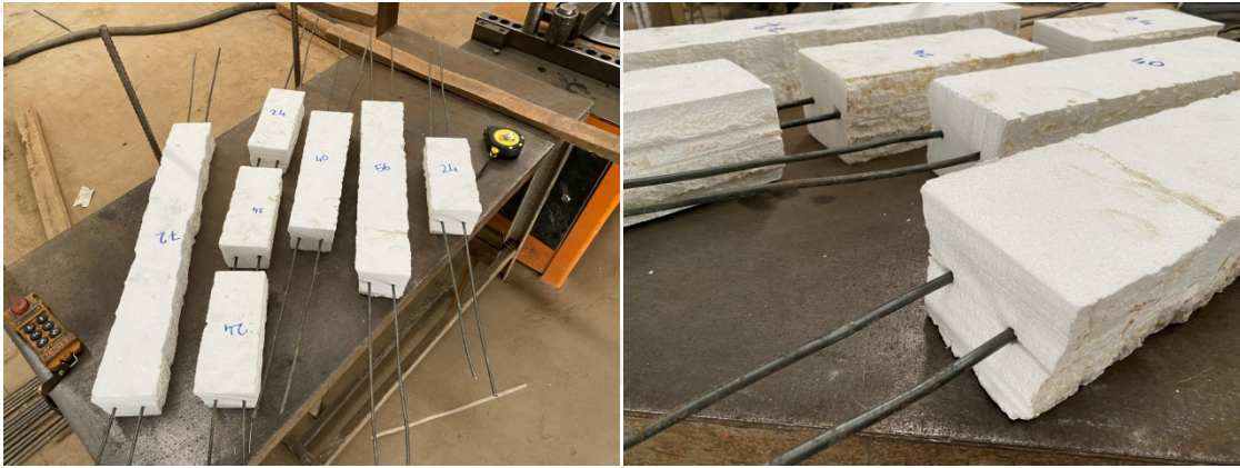
Şekil 3.16. Boşluk straforlarının üretime hazırlanması
