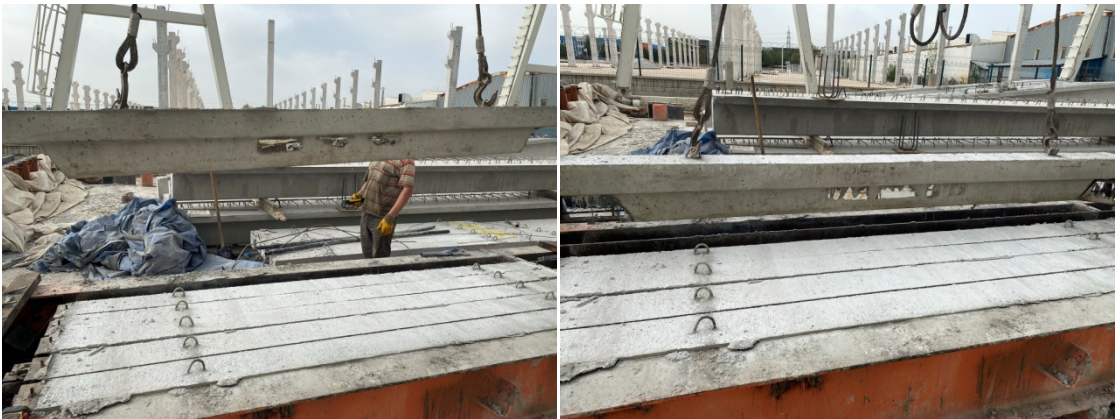
Şekil 3.52. Sırasıyla P-5 ve PP-5 numaralı aşıkların kalıptan alınması
