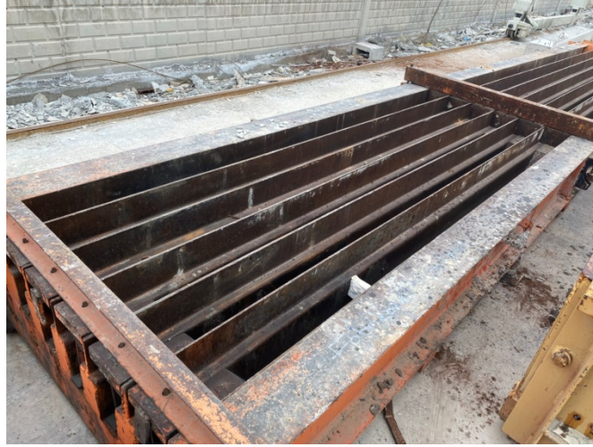
Şekil 3.14. Üretimin yapılacağı kalıbın stok alanından üretim sahasına getirilip yerleştirilmesi
