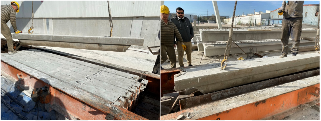
Şekil 3.31. Sırasıyla PP-0 ve PP-1 kod numaralı aşıkların kalıptan çıkarılması
