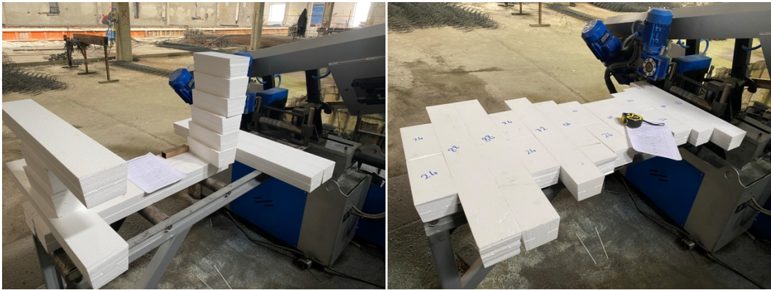
Şekil 3.13. Kesim sonrası straforların gruplandırılması
