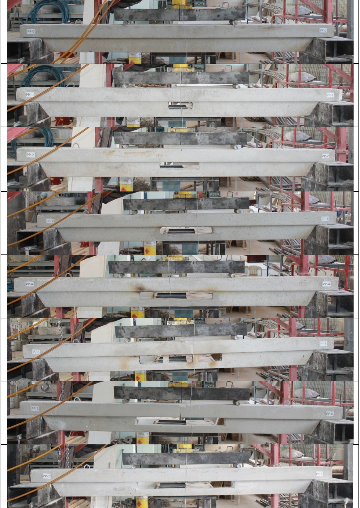
Şekil 3.63. Öngerilmeli kirişlerin deney başlangıç gösterimi
