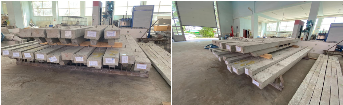
Şekil 3.58. Deney düzenine göre etiketleme işleminin tamamlanması
