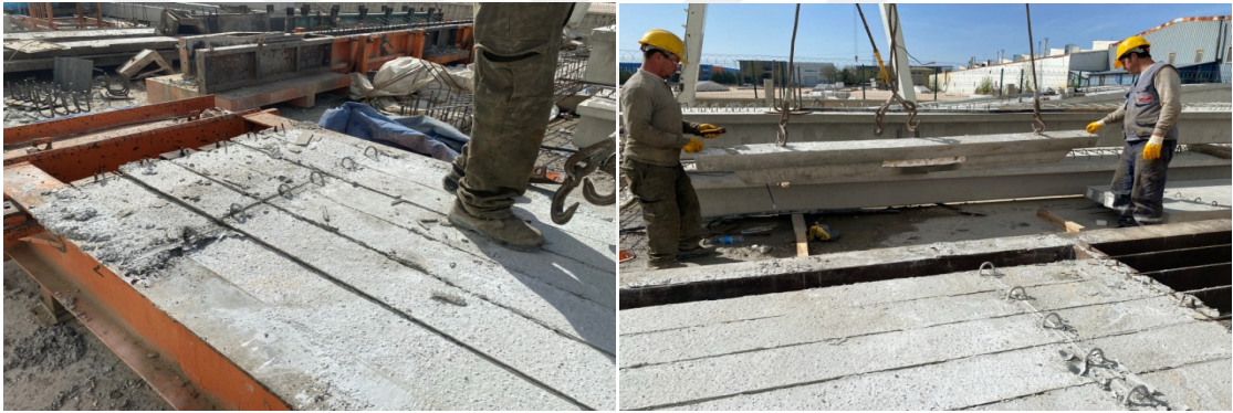
Şekil 3.41. Şok sarsma ve P-4 numaralı kirişin kalıptan alınması.
