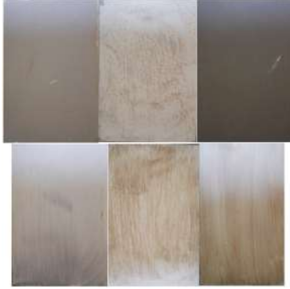
Şekil 4. Galvaniz kaplı olmayan saclara uygulanmış ticari, PE20 ve PE0-C20 boyalar ile boyanmış sacların fotoğrafları (TTB3, TTB2, TTB4 (üst soldan sağa), TTB1, PE20, PE0-C20 (alt soldan sağa)) Figure 4. Photos of painted sheets by commercial, PE20 and PE0-C20 paints applied to non-galvanized sheets (TTB3, TTB2, TTB4 (top left to right), TTB1, PE20, PE0-C20 (bottom left to right))
