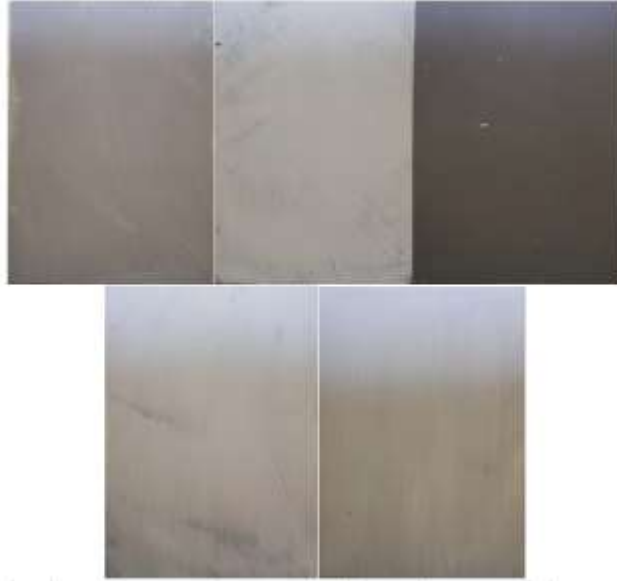
Şekil 5. Galvaniz kaplı saclara uygulanmış ticari ve PE0-C20 boyalar ile boyanmış sacların fotoğrafları (TTB3, TTB2, TTB4 (üst soldan sağa), TTB1, PE0-C20 (alt soldan sağa)) Figure 5. Photos of painted sheets by commercial and PE0-C20 paints applied to galvanized sheets (TTB3, TTB2, TTB4 (top left to right), TTB1, PE0-C20 (bottom left to right))
