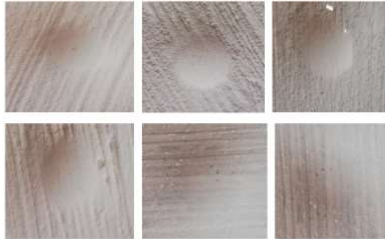
Şekil 8. Galvaniz saca kaplanmış ticari, PE20 ve PE0-C20 boyaların darbe testi görünüşleri (TTB1, TTB3, TTB4 (üst soldan sağa), TTB2, PE20, PE0-C20 (alt soldan sağa))
