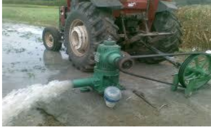
Şekil 2. Düsey Milli Pompa Figure 2. Vertical Shaft Pump
