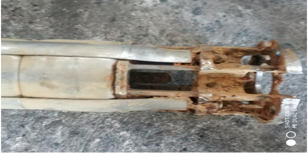
Şekil 6. Hatalı malzeme kullanımı sonucu kaplinin kopması
