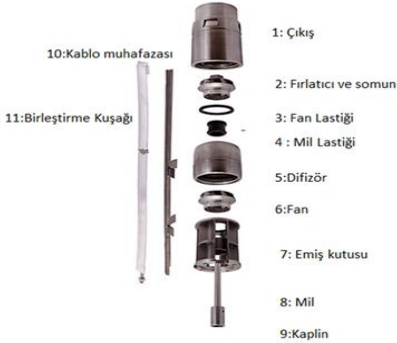
Şekil 5. Krom dalgıç pompa Figure 5. Chrome submersible pump
