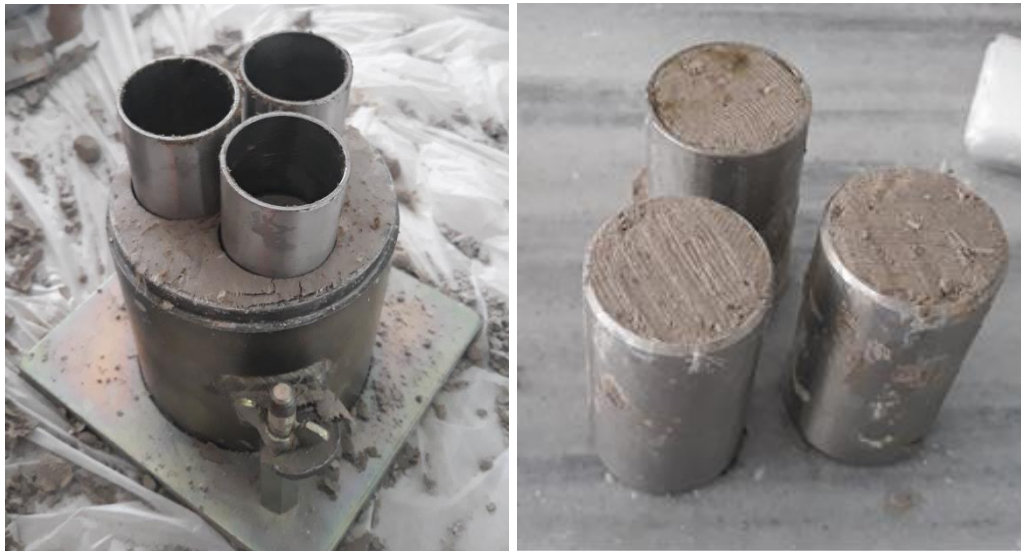
a b Şekil 3.15. (a) Sıkıştırılan zeminden serbest basınç deneyi için numune alınması (b) Numune alınan silindir tüpler
