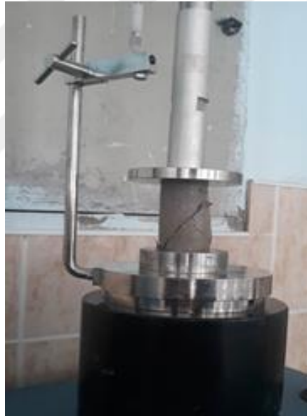
Şekil 4.2 Suya doymun numune serbest basınç deney sonucu eksenel boy kısalması
