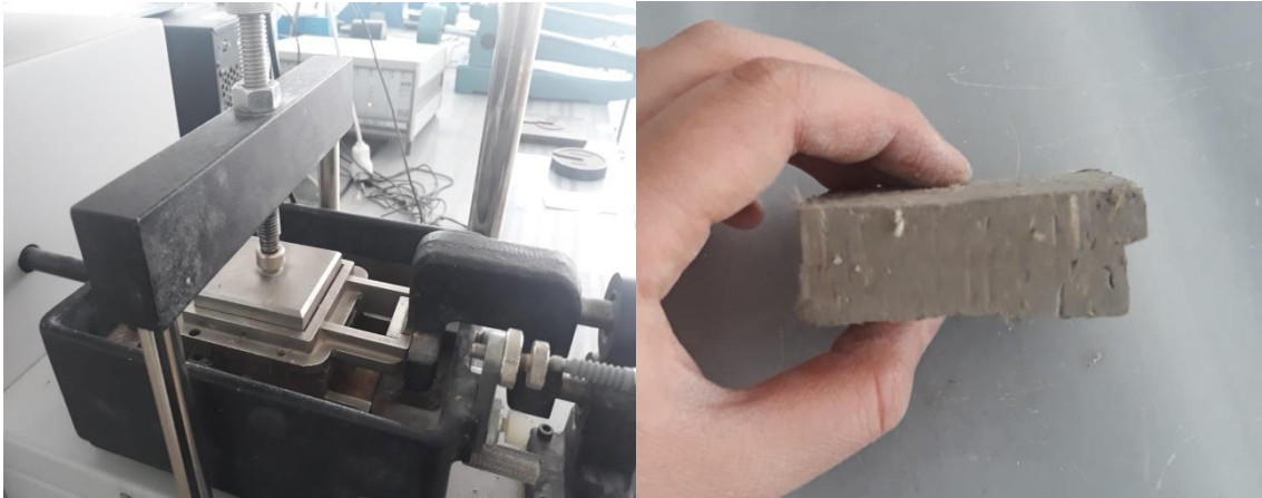
Şekil 4.3.(a) Kesme kutusu deneyi (b) Kesilen numune
