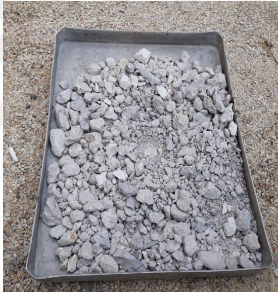
Şekil 3.1. Etüvde kurutulmuş doğal kil zemin
