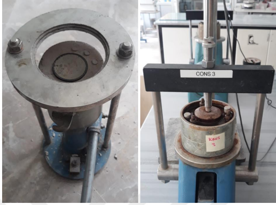
Şekil 3.17. (a) Sıkıştırılan zeminden konsolidasyon deneyi için numune alınması (b) Konsolidasyon hücresi
