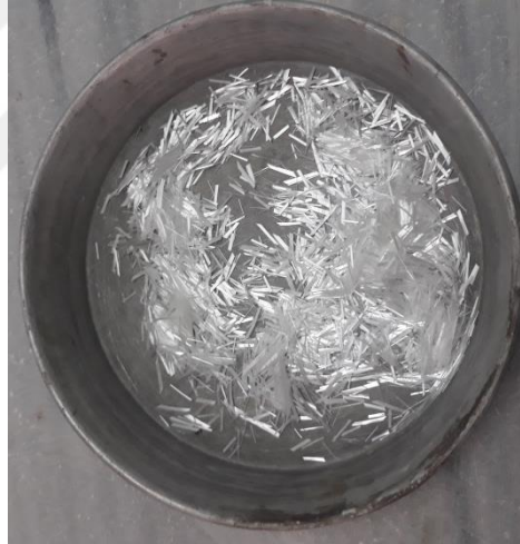
Şekil 3.3. Deneyde kullanılan cam lifi
