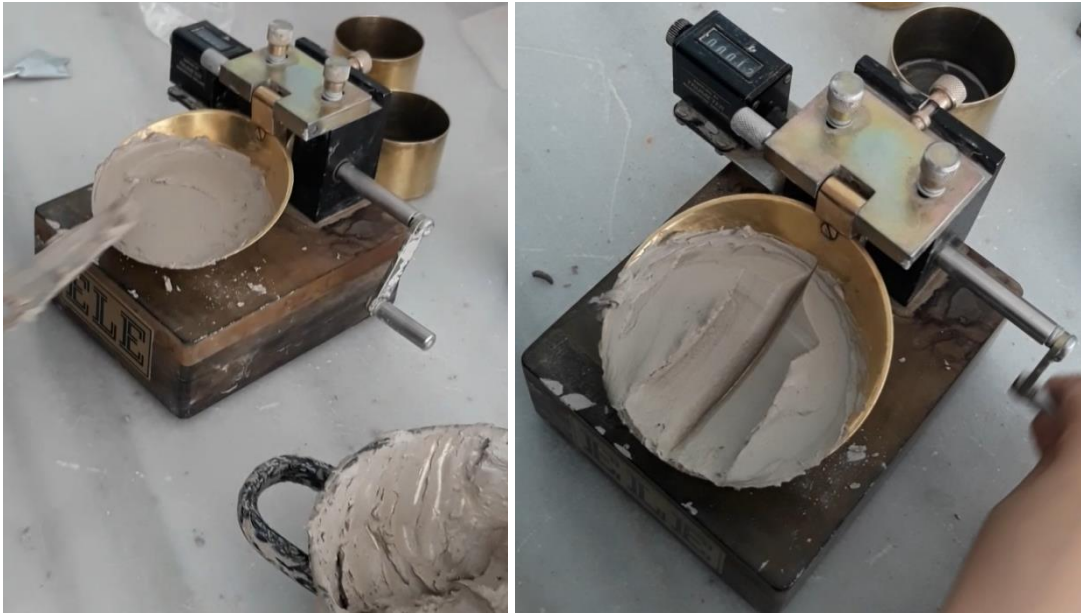
a b Şekil 3.7.(a)- (b) Casagrande deneyi ile likit limitin belirlenmesi
