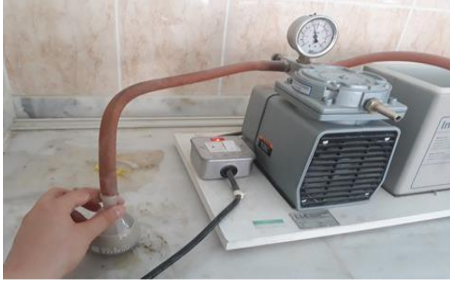
Şekil 3.6. Piknometre deneyinde vakumlama işlemi
