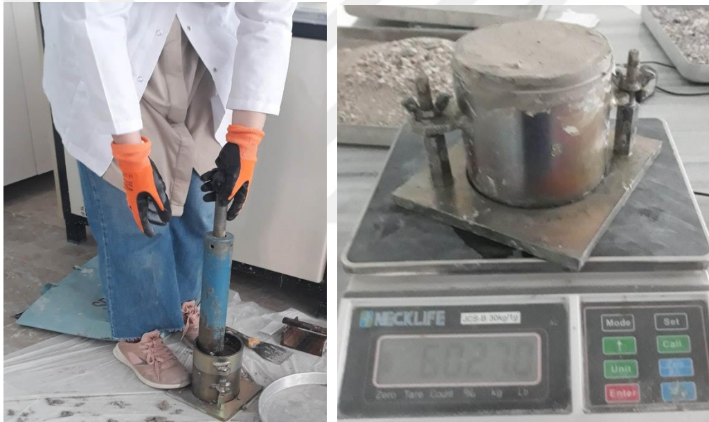
Şekil 3.11.(a) Kompaksiyon deneyi (b) Kompaksiyon kalıbının tartılması işlemi
