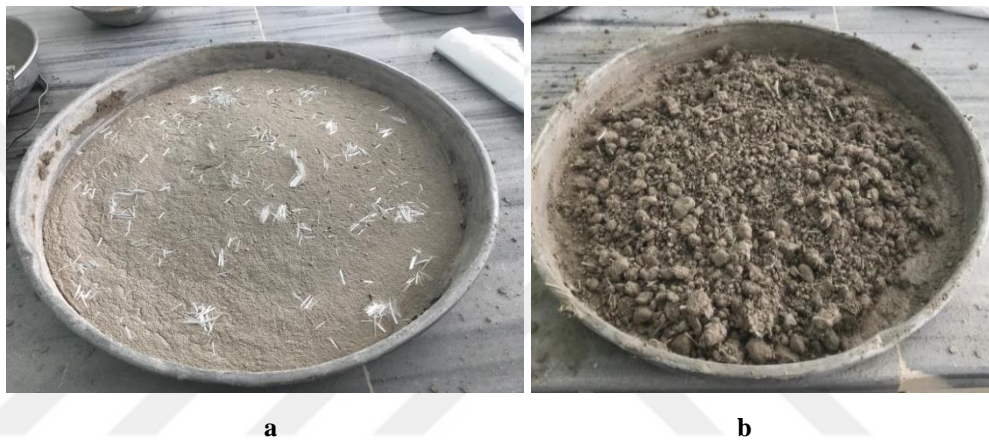
Şekil 3.13.(a) Kil zemine cam lifi eklenmesi (b) Cam lifinin kil zemine karıştırılması
