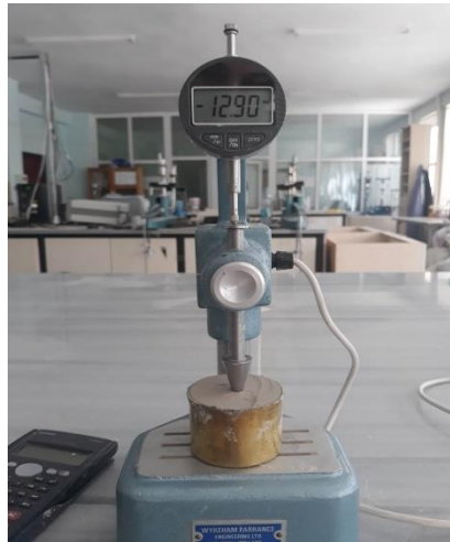
Şekil 3.9. Koni penetrasyon deneyi
