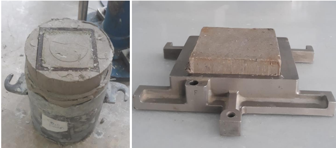
a b Şekil 3.16.(a) Sıkıştırılan zeminden kesme kutusu deneyi için numune alınması (b) kesme kutusu hücresi
