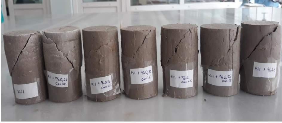
Şekil 4.1 Serbest basınç deney sonrası kırılan numuneler
