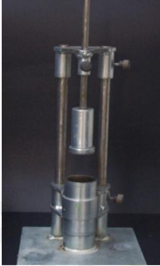
Şekil 3.14. Modifiye edilmiş, minyatür Harvard kompaksiyon aleti
