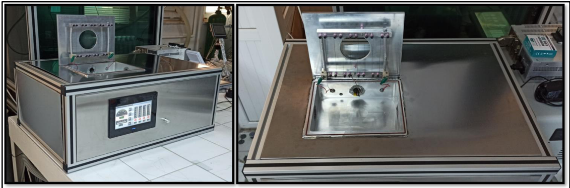
Şekil 1.7. MCM firması tarafından geliştirilen iCVD kaplama sistemi
