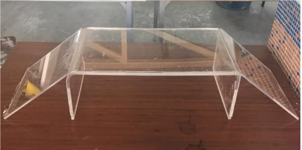
(b) Y/X=1/2 şev eğimli geniş başlıklı savak Şekil 3.9. Şevli geniş başlıklı savak modelleri
