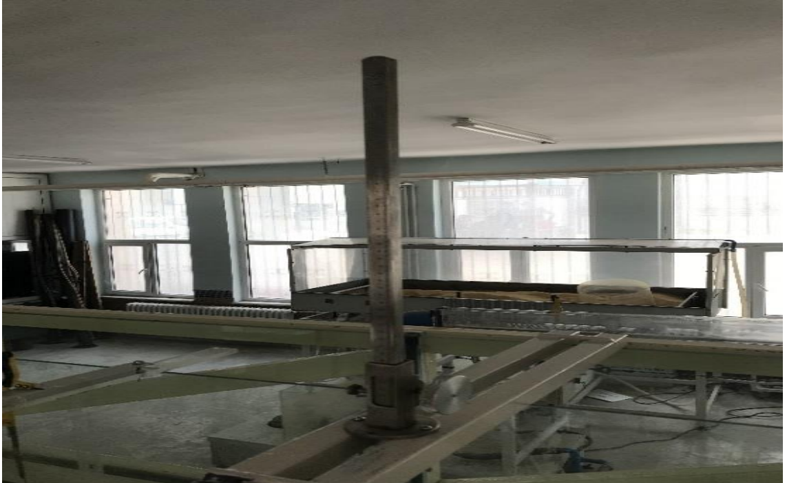
(b) Savak yükü ölçümünde kullanılan limnometre.
