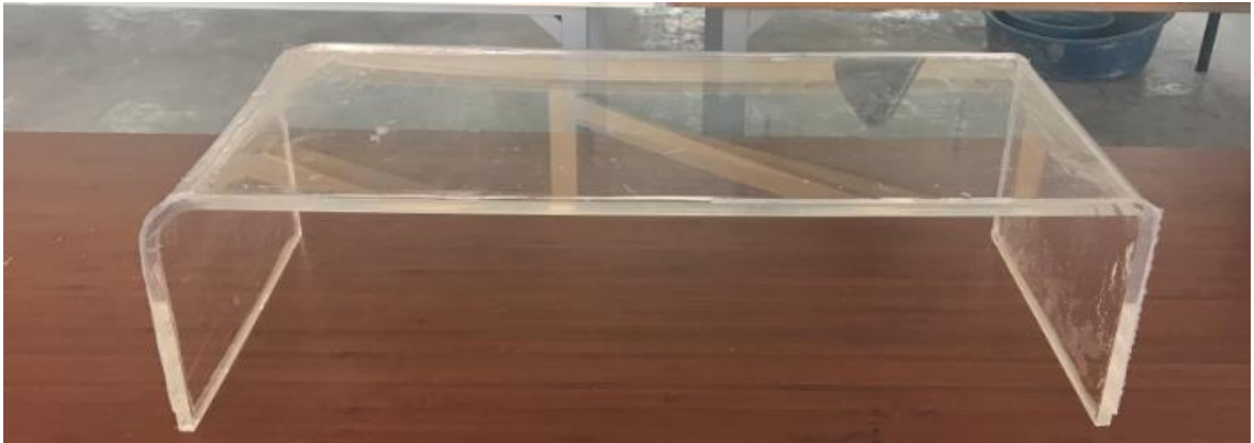
Şekil 3.8. Memba köşesi yuvarlatılmış dikdörtgen kesitli geniş başlıklı savak
