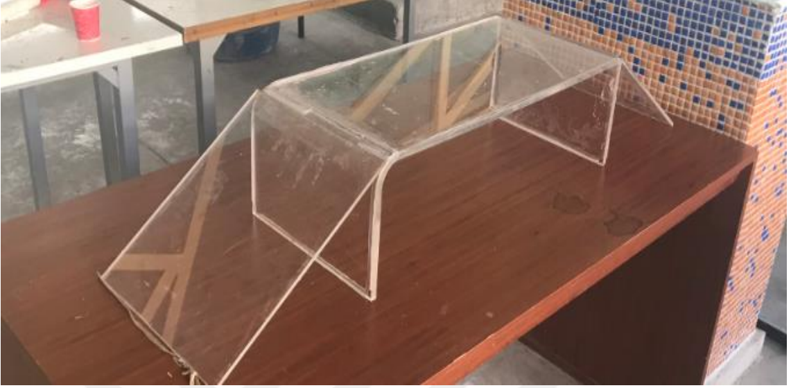
(a) Y/X=1/1,5 şev eğimli geniş başlıklı savak modeli
