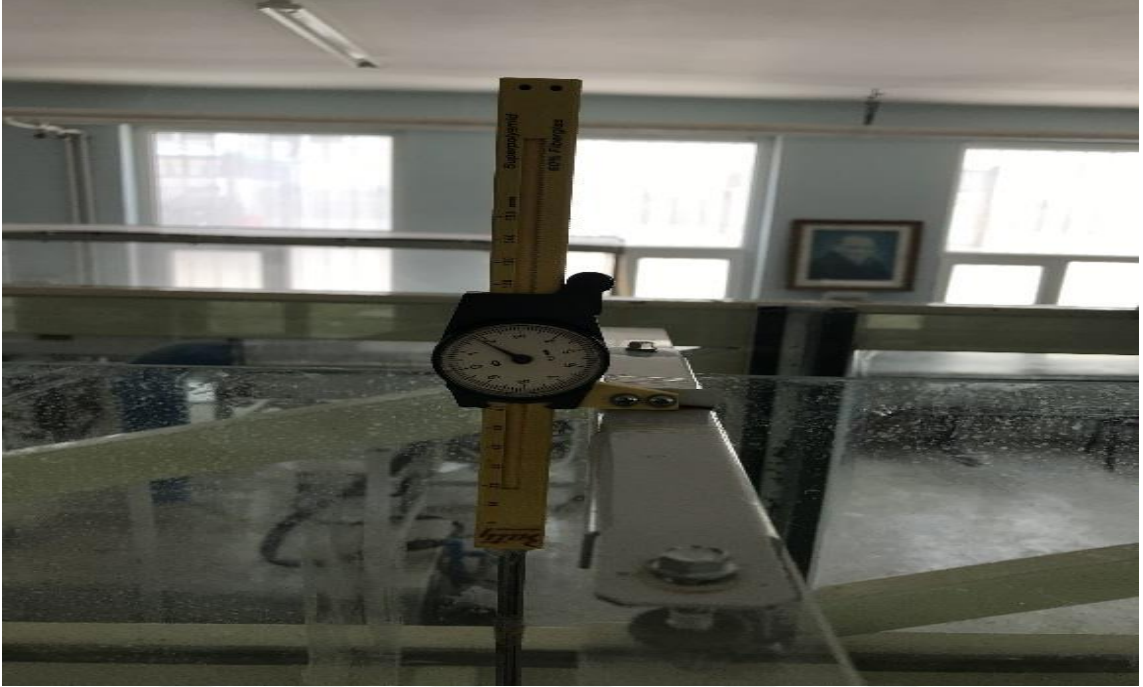
(a) Kritik yükseklik ölçümünde kullanılan limnometre
