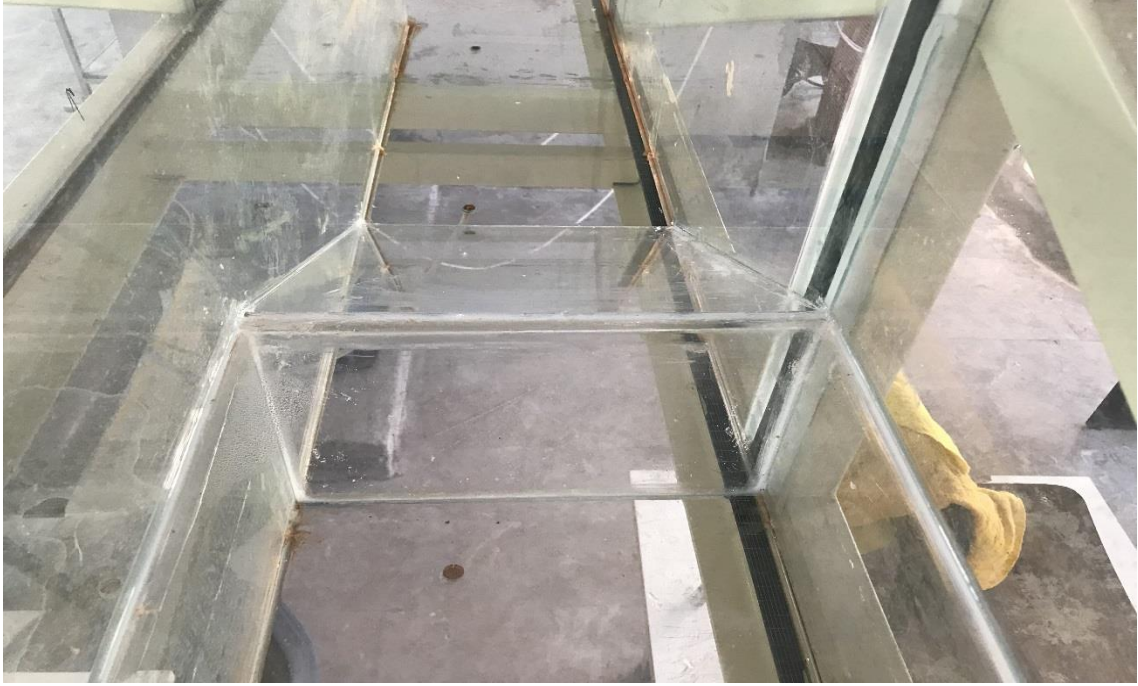
Şekil 3.7. Pleksiglas malzemeden oluşturulan modelin silikonla kanala sabitlenmesi
