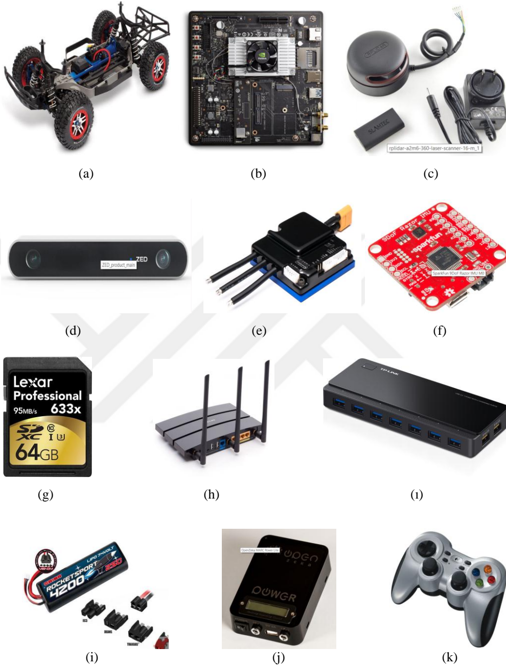
Şekil 3.3. a) Araç platformu, b) NVIDIA İşlemci, c) LIDAR, d) Kamera, e) Açık kaynak elektronik hız kontrolcüsü, f) IMU, g) SD kart, h) Modem, ı) 7 girişli USB3.0-hub, i) Lityum Polimer pil, j) Platform ve Sensörler için batarya, k) Joystick.
