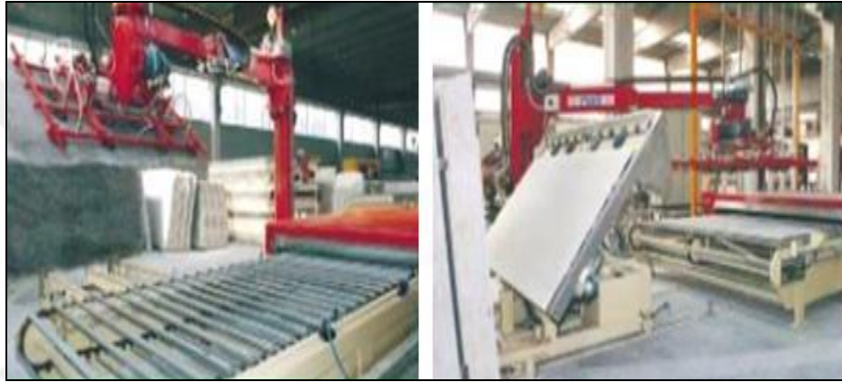
Şekil 5.8. Robot kol tarafından yapılan plaka istiflemesi (Megep, 2011)
