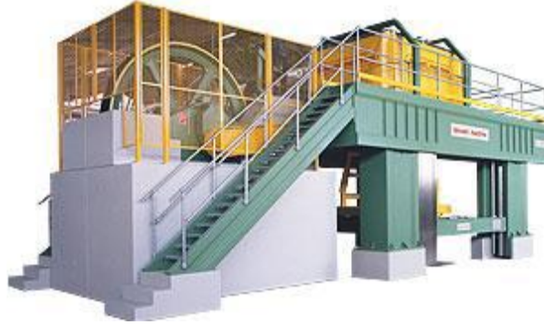
Şekil 5.1. Lamalı blok kesme, katrak, makinesi (Megep, 2011)
