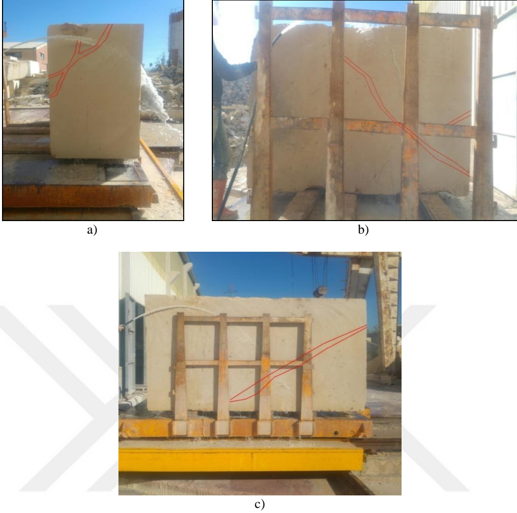
Şekil 7.1 Taşıma vagonuna yerleştirilen Elazığ-Krem mermer örneğinin 1. bloğunda (ElKr-blok1) gözlenen süreksizlik hatları. a) Bloğun genişlik ölçülen boyutu, (genişlik yüzeyi, ön yüzey), b) Bloğun gösterilen genişlik resmine göre sağ tarafında kalan uzunluk boyutu, (sağ yüzeyi) c) Bloğun gösterilen genişlik resmine göre sol tarafında kalan uzunluk boyutu, (sol yüzeyi).
