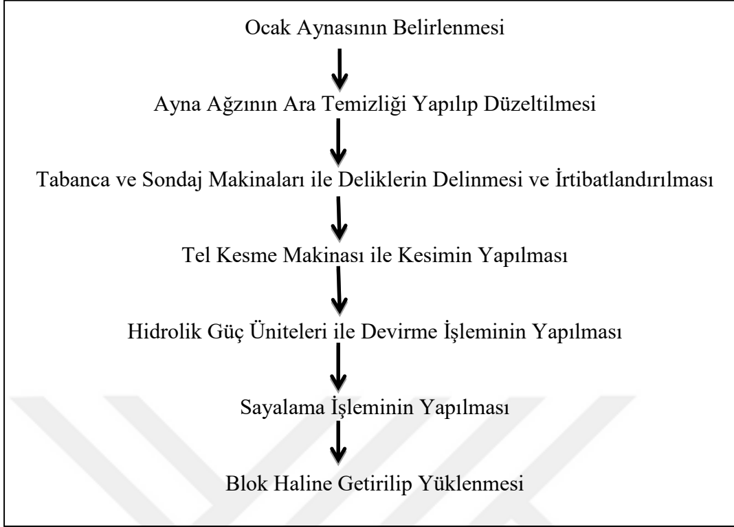
Şekil 1.1. Mermer işletmesinde üretim ve işleyiş sıralaması (Anadolukobi Mermer, 2010)
