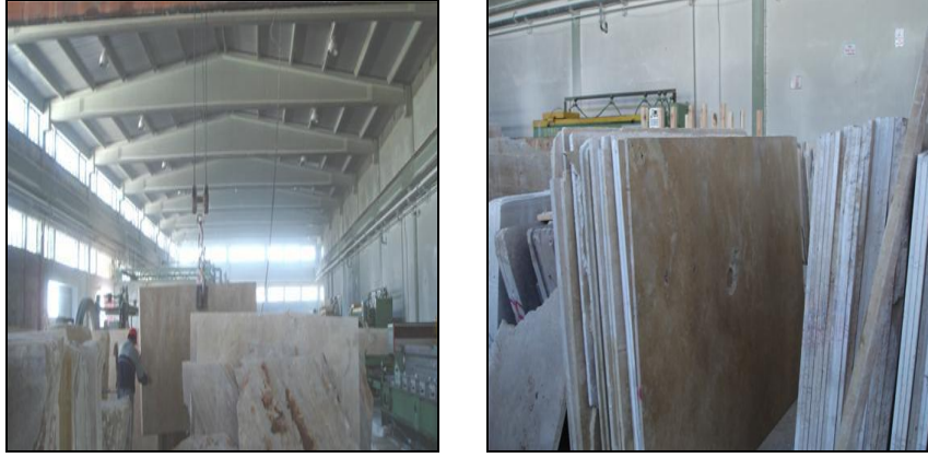
Şekil 5.7. Katrak makinesi çıkışında taşıyıcı vagondan vinç yardımıyla plakaların alınarak, kesilmiş plaka stok yerlerine konulması (Megep, 2011)
