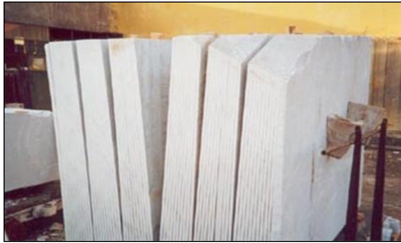
Şekil 5.6. Doğaltaş blok kesiminin tamamlanması ve taşıyıcı vagonun katrak makinesinde çıkartılması (Megep, 2011)
