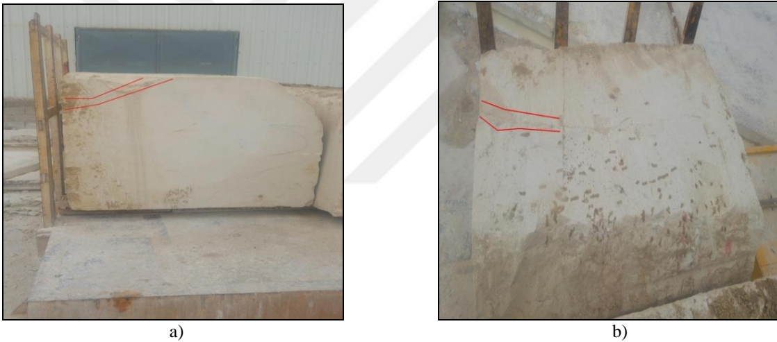
Şekil 7.9. Taşıma vagonuna yerleştirilen Elazığ-Krem mermer örneğinin 4. bloğunda (ElKr-blok4) gözlenen süreksizlikler a) Bloğun arka kısa boyutu (arka yüzey) b) Bloğun tavan ön boyutu.
