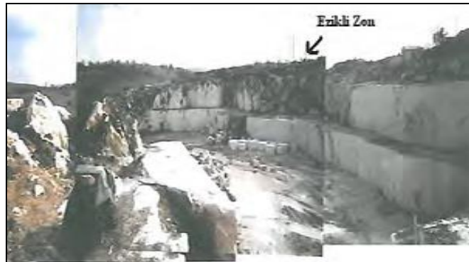
Şekil 3.1. Pıynarlı Tepe güneyindeki mermer ocağı. Ocak şevlerinde ezik zonlar ve karstik boşluklar (Uz ve Yıldız, 2017)
