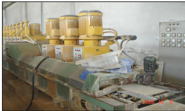
Şekil 5.11. Doğaltaş kesme fabrikalarında kullanılan, 3+12 başlıklı, kafalı, kalibre özelliğine sahip cilalama, polisaj, makinesi (Megep, 2011)
