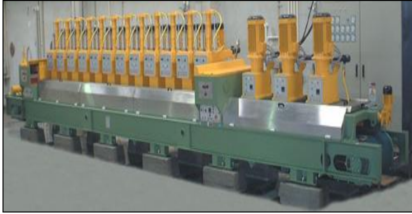
Şekil 5.12. Fayans hattı cilalama makinesi, 3+12 başlıklı makine (Megep, 2011)
