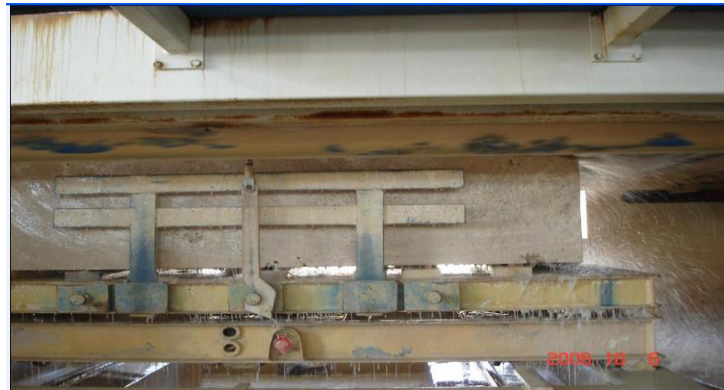
Şekil 5.3. Transfer arabası ve vagon yardımıyla blok yüklemesi ve sabitlemesi (Megep, 2011)
