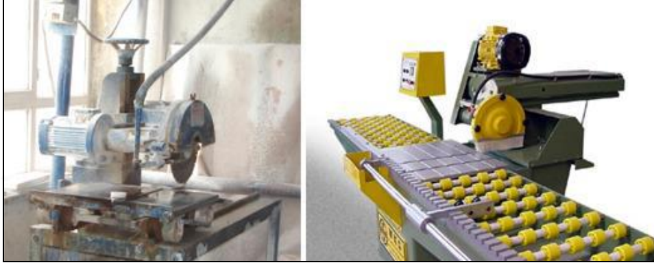
Şekil 5.10. Doğaltaş kesme fabrikalarında kullanılan kafa kesme makineleri (Megep, 2011)
