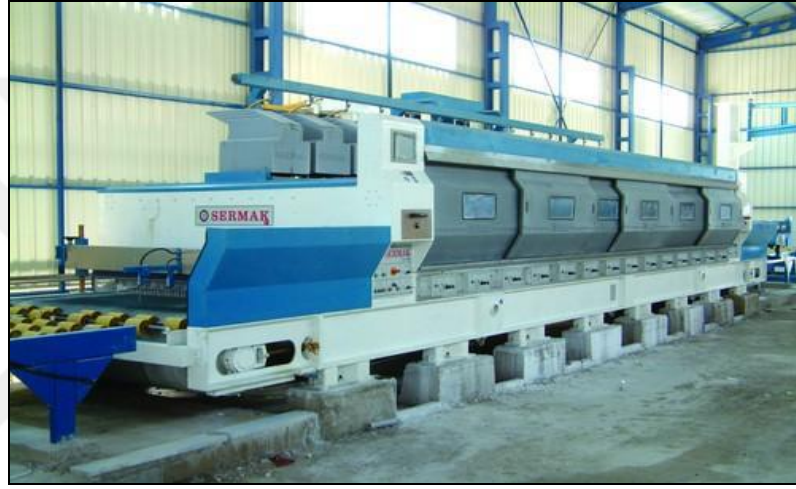
Şekil 5.13. Plaka hattı cilalama makinesi (Megep, 2011)
