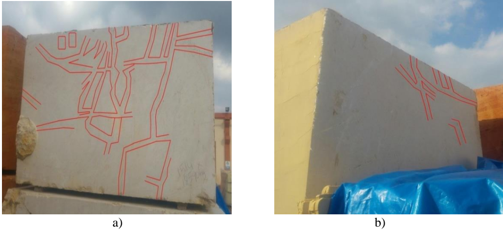
Şekil 7.19. Stok alanında incelenen ve süreksizlikleri işaretlenen BzOn-blok5'in görünümü a) ) Bloğun genişlik ölçülen boyutu, (genişlik yüzeyi, ön yüzey), b) ) Bloğun genişlik ölçülen boyutu, (genişlik yüzeyi, arka yüzey),
