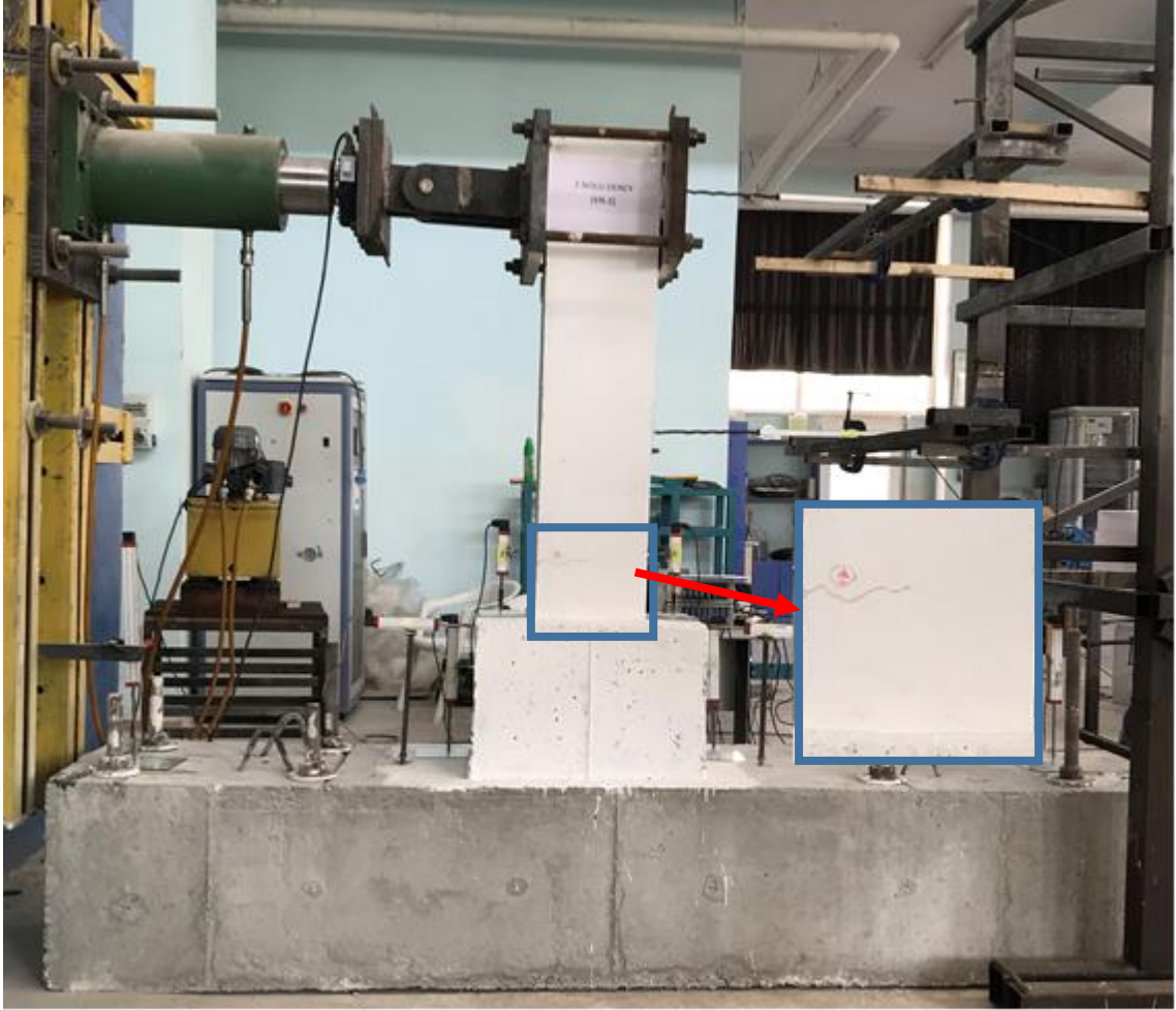
Şekil 4.15. KN2 numunesinde ilk çatlak oluşumu
