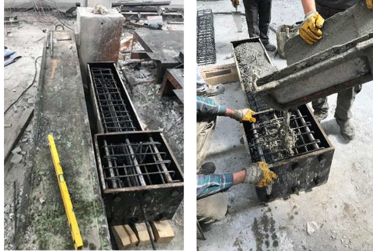
Şekil 3.17. AN5 ve AN7 numunelerinin üretim aşamaları
