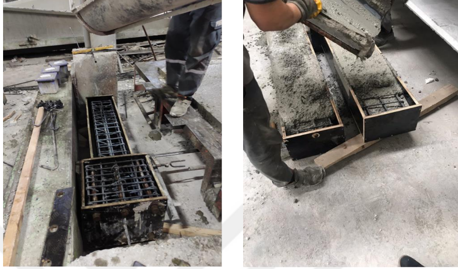
Şekil 3.18. AN8 ve AN9 numunelerinin üretim aşamaları
