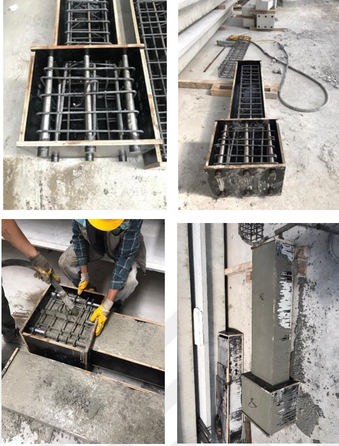
Şekil 3.16. AN4 ve AN6 numunelerinin üretim aşamaları
