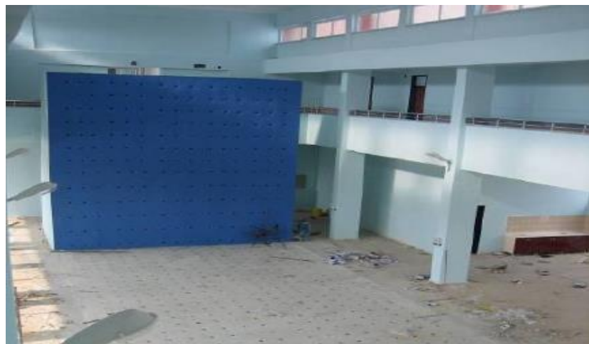
Şekil 3.28. Konya Teknik Üniversitesi, Deprem Laboratuvarı reaksiyon duvarı ve döşeme (Balık, 2012)
