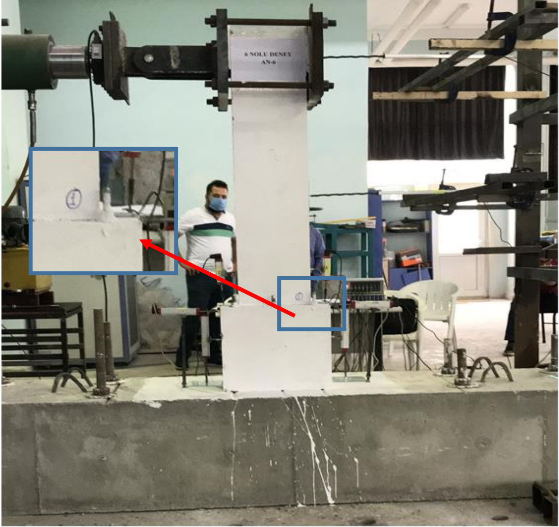
Şekil 4.59. AN6 numunesinde ilk çatlak oluşumu
