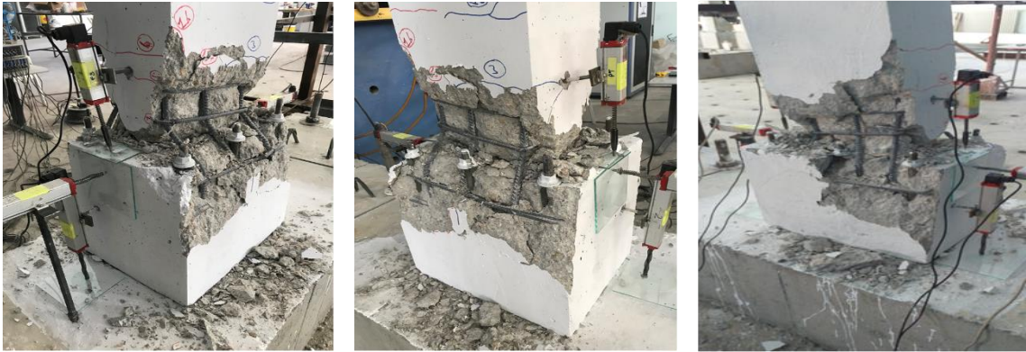
Şekil 4.72. AN7 numunesinin göçme durumuna ulaştığında hasar durumu
