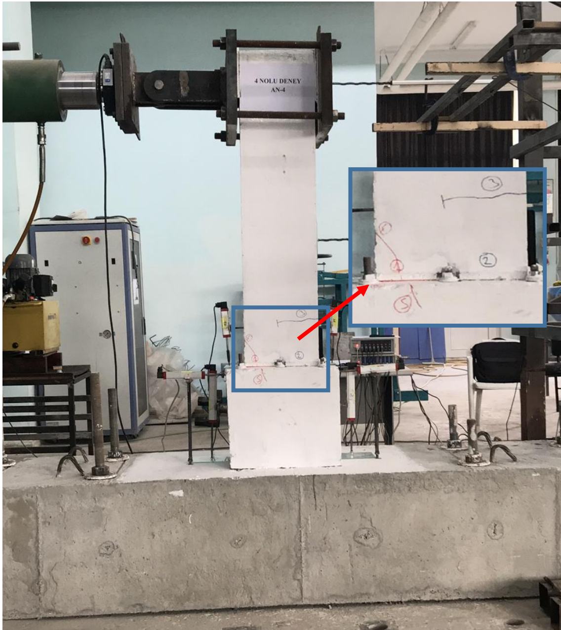
Şekil 4.38. AN4 numunesinin akma dayanımına ulaştığında hasar durumu
