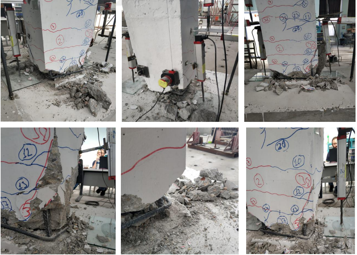
Şekil 4.6. KN1 numunesinin göçme durumuna ulaştığında hasar durumu
