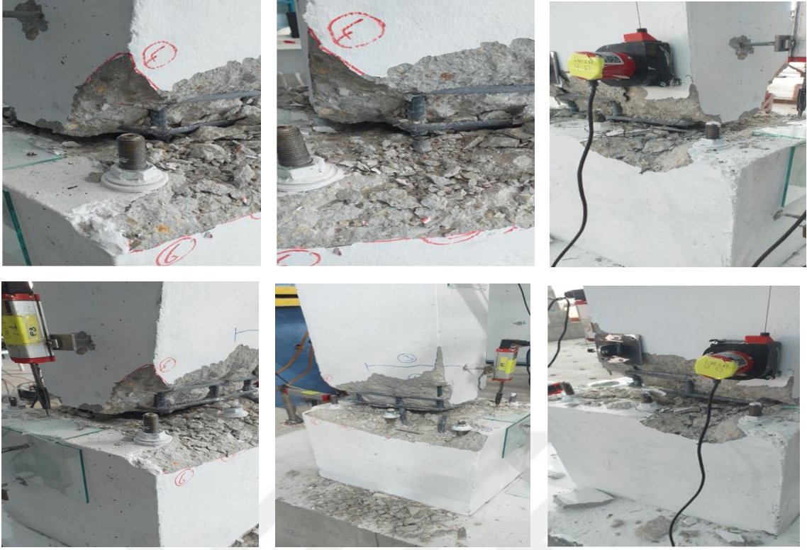
Şekil 4.39. AN4 numunesinin göçme durumuna ulaştığında hasar durumu
