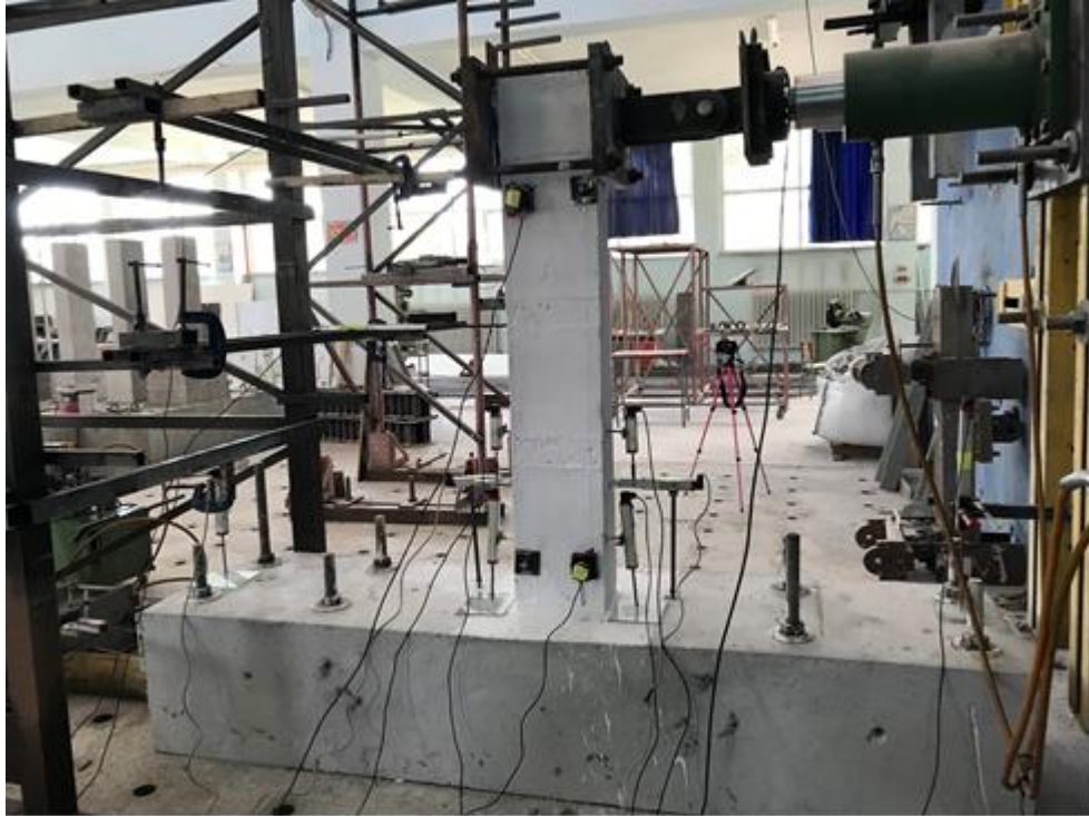
Şekil 3.33. Numune üzerinde LVDT yerleşimi
