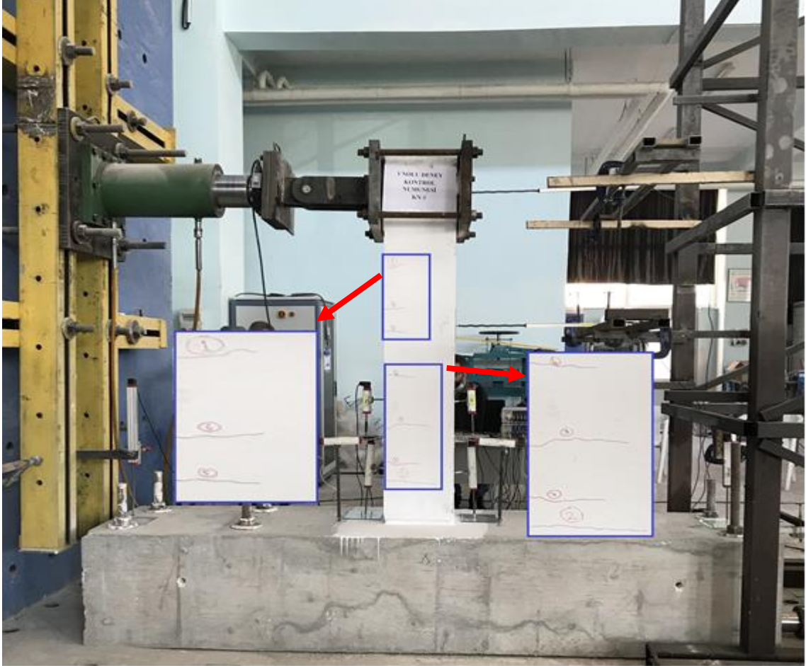
Şekil 4.4. KN1 numunesinde ilk çatlak oluşumu
