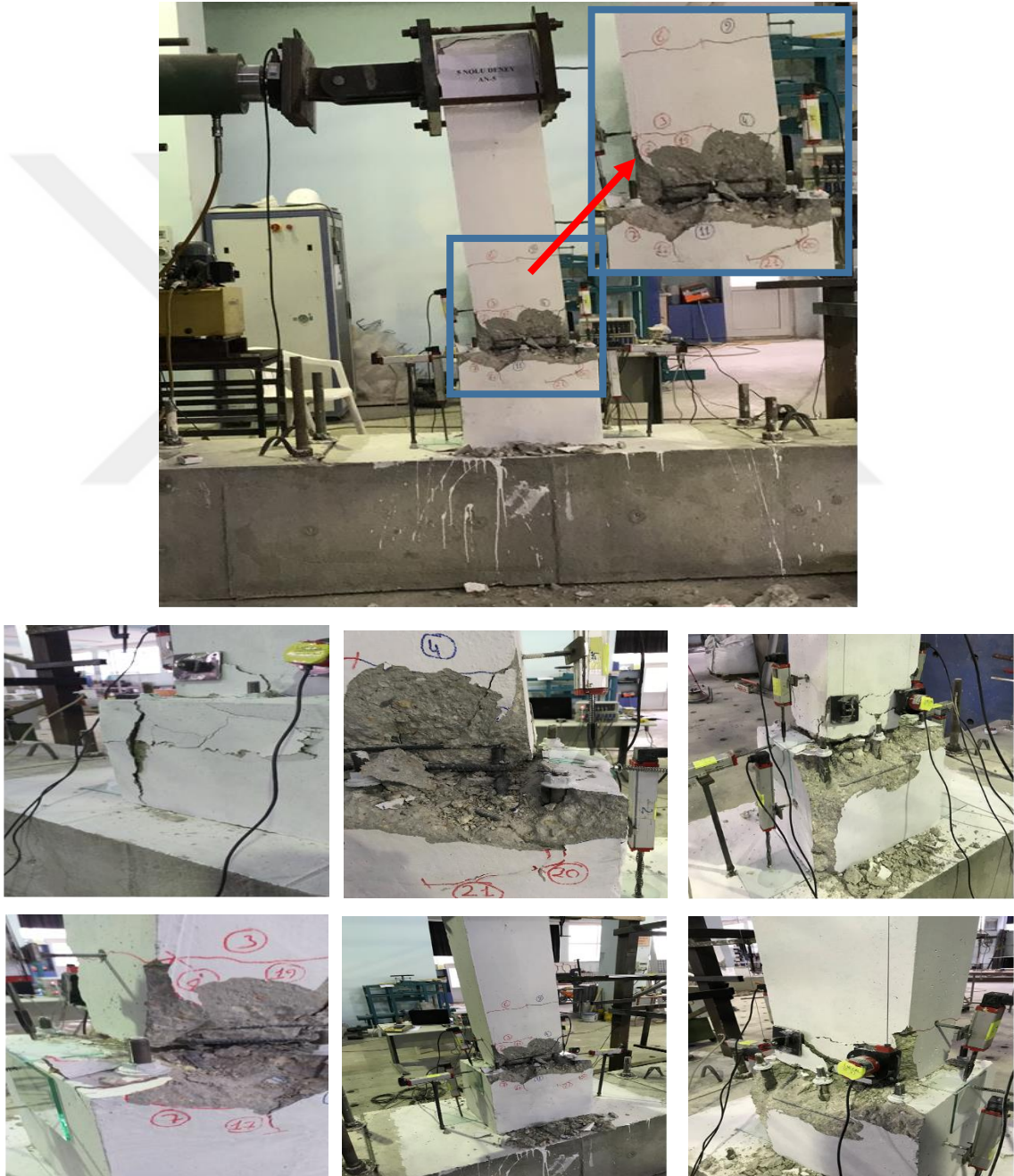
Şekil 4.50. AN5 numunesinin göçme durumuna ulaştığında hasar durumu
