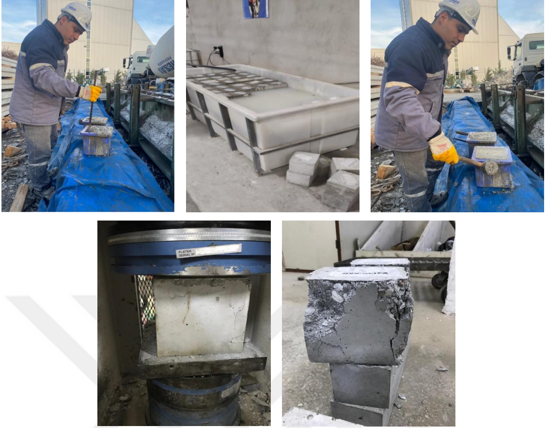
Şekil 3.19. Küp numunelerin alınması, kür edilmesi, basınç testi aşamaları
