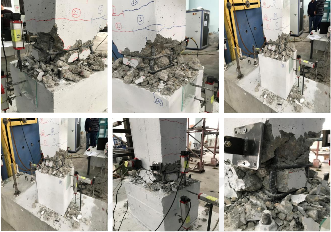
Şekil 4.83. AN8 numunesinin göçme durumuna ulaştığında hasar durumu
