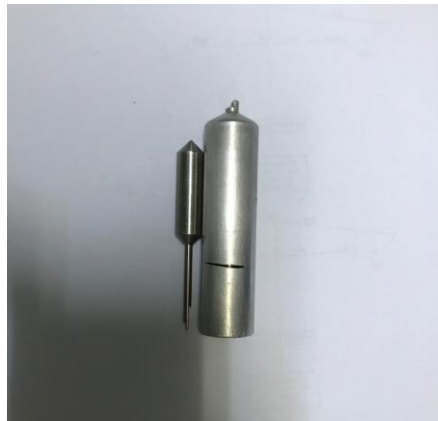
Şekil 3.8. Çalışmada kullanılan numune haznesi ve spindle
