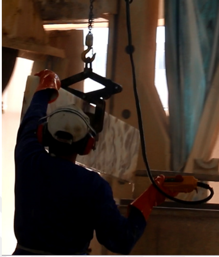
Şekil 3.31. Ebatlama 2 makinasına taşıma yapan işçi (1)
