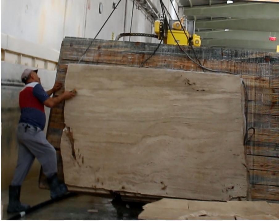
Şekil 3.10. Mermer plakalarının blok çevirme makinasına yerleştirilmesi
