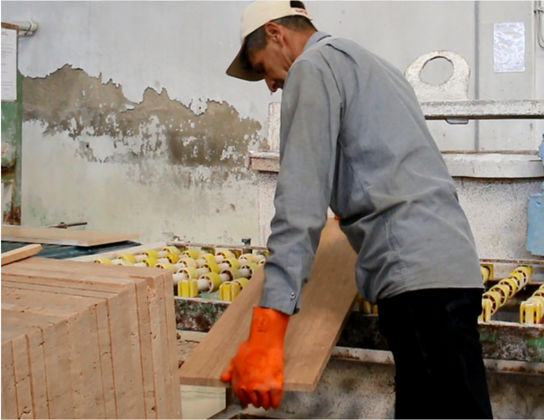
Şekil 3.13. Dolgu makinasını boşaltma işlemi yapan bir işçi
