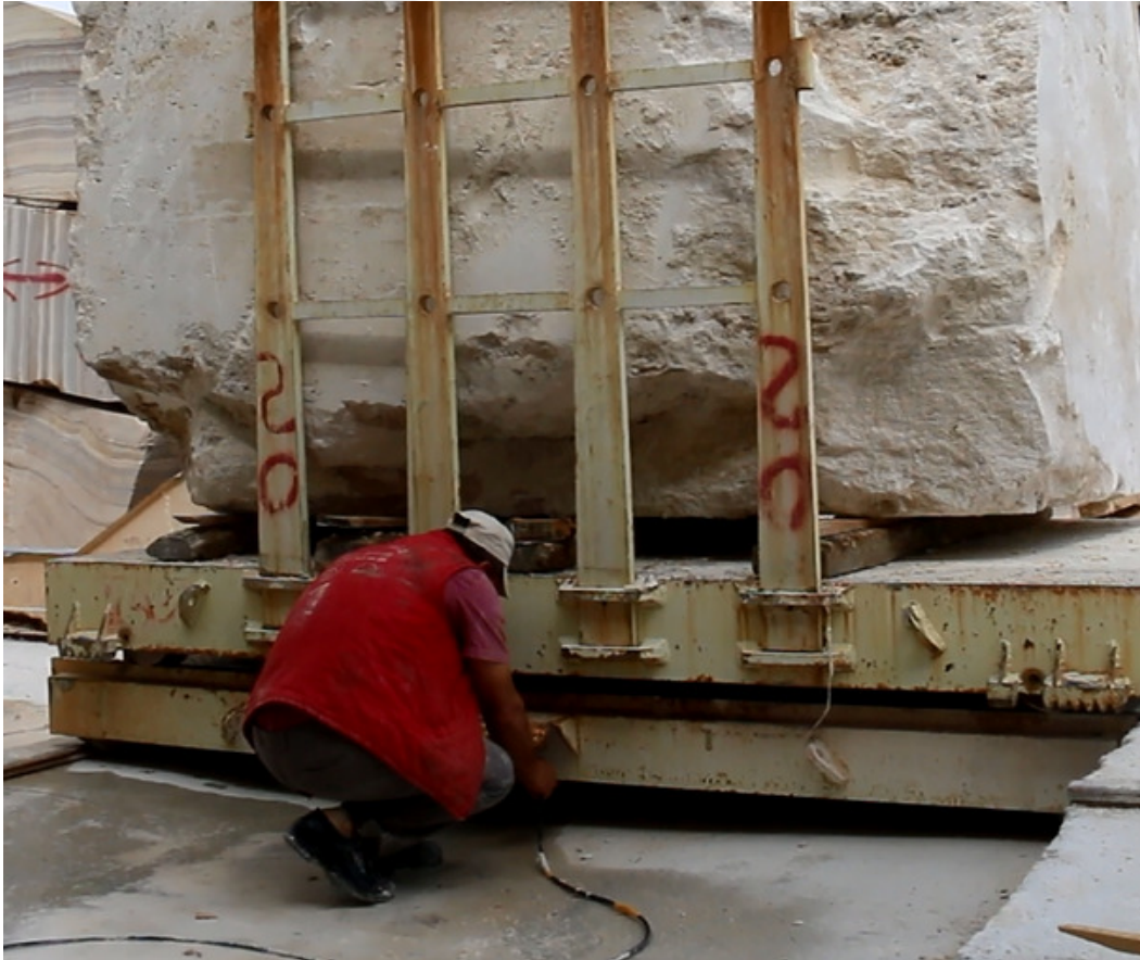
Şekil 3.6. Mermer bloklarının kesme makinası arabasına yüklenmesi
