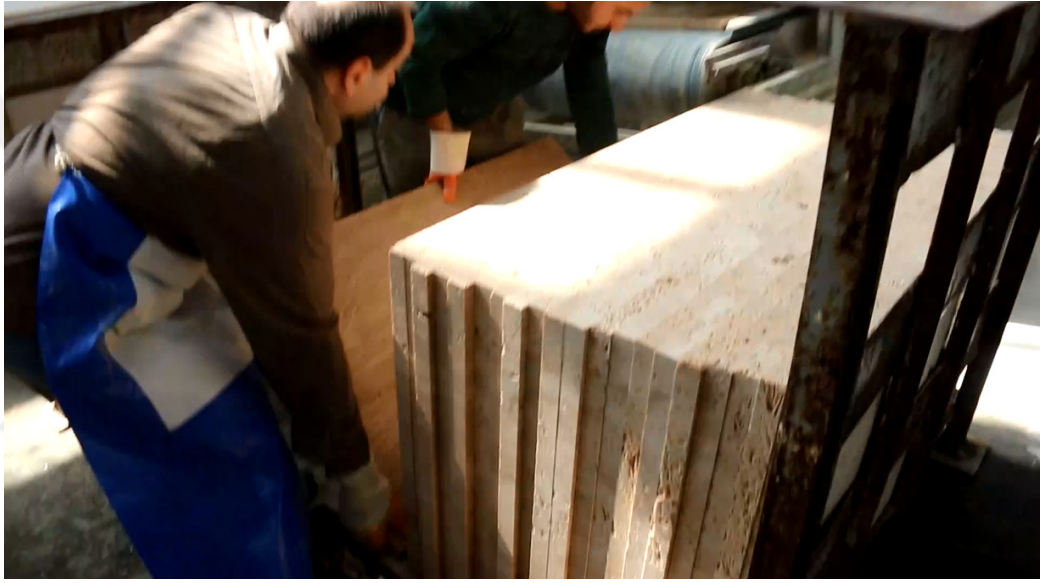
Şekil 3.23. Dolgu+Honlama makinasına yükleme yapan işçiler
