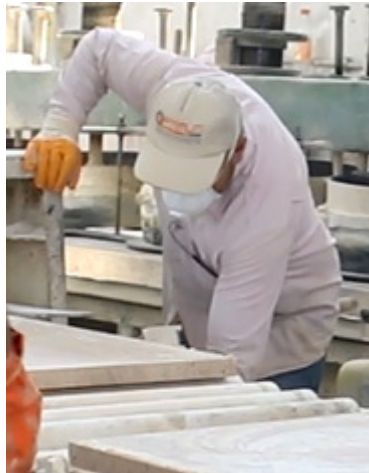
Şekil 3.24. Dolgu+Honlama makinasında işlem yapan işçi
