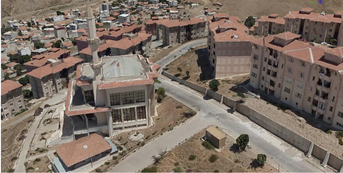
Şekil 3.25. Çalışma alanına ait eğik fotogrametrik yöntemle oluşturulan katı model
