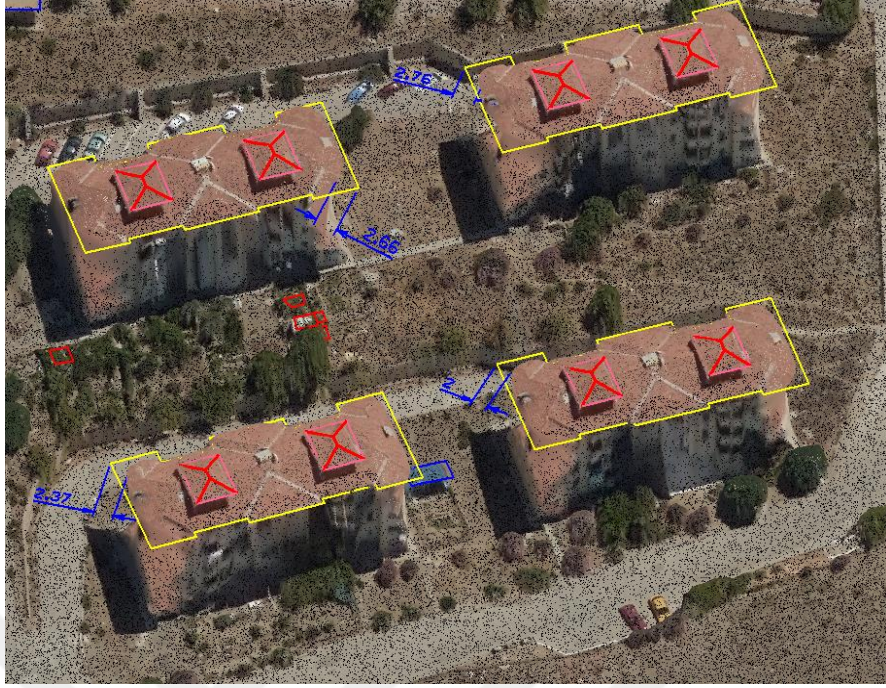
Şekil 4.5. Klasik fotogrametrik yöntemle üretilen nokta bulutu verisi ile çatı köşelerinin ölçümü
