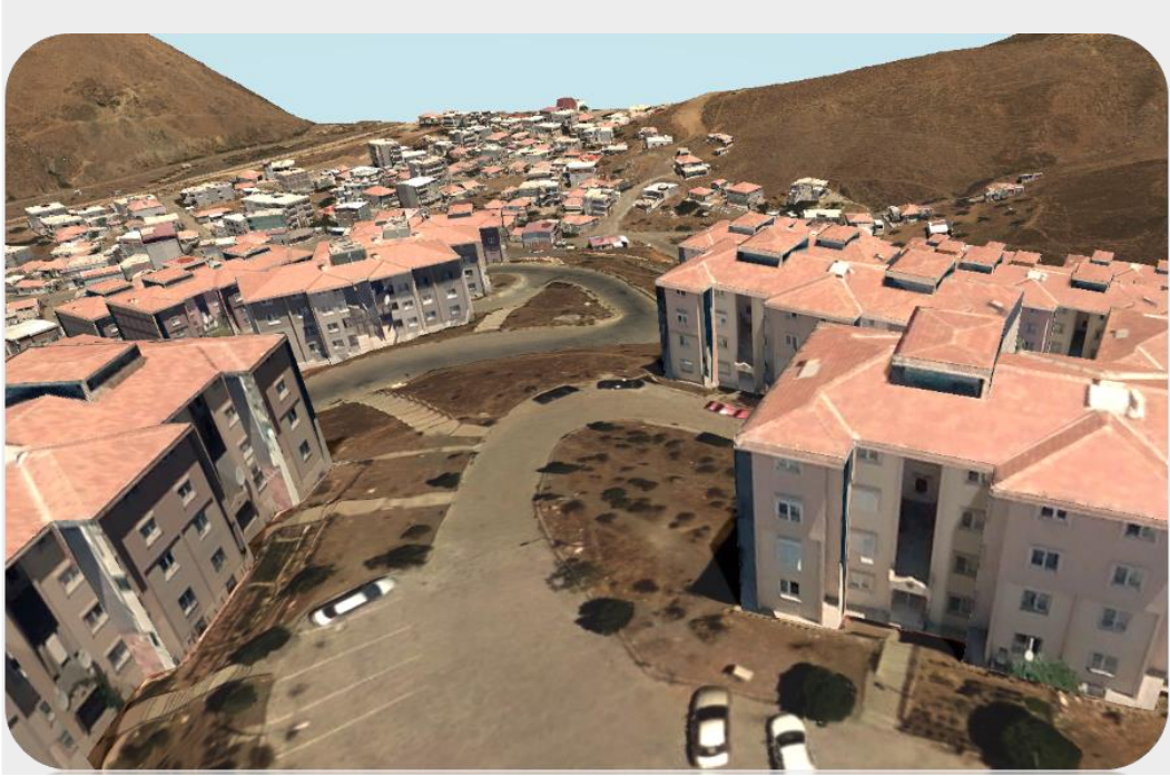
Şekil 3.24. Çatı detaylarının zemine indirgenmesiyle oluşturulan katı model
