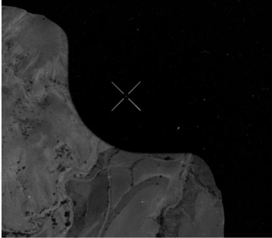
Şekil 3.17. İç yöneltmenin belirlenmesinde kullanılan ölçüm nokta örneği
