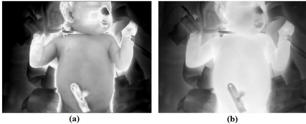
Şekil 2. 8. (a) 30–40°C aralığında renklendirilerek kaydedilmiş termal görüntünün gri seviyeli hali (b) sıcaklık haritalarının görselleştirilmesi ile oluşan termal görüntü
