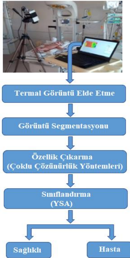
Şekil 3. 1. Önerilen sistemin blok diyagramı
