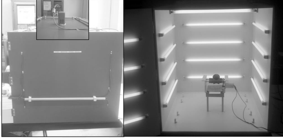
Şekil 2.7. Kahverengi yumurtalarda kusur tespit sistemi (K. Mertens ve arkadaşları, 2005)
