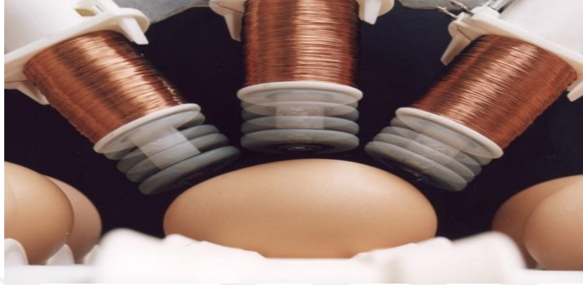
Şekil 2.4. Akustik algılayıcılarla çatlak tespit etme (Web3, 2019)
