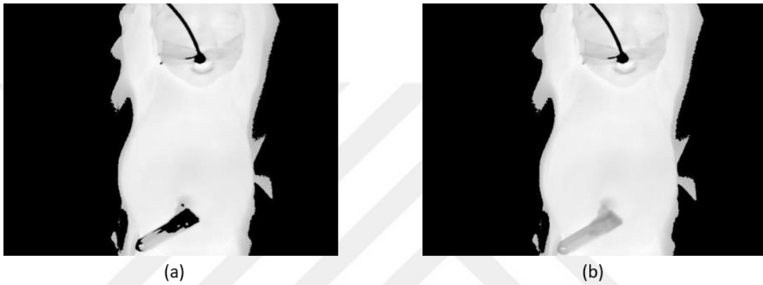
Şekil 3.8. (a) Göbeğinde mandal taşıyan bir yeni doğana ait sıcaklık haritası (b) boşluk doldurma uygulandıktan sonra oluşan görüntü
