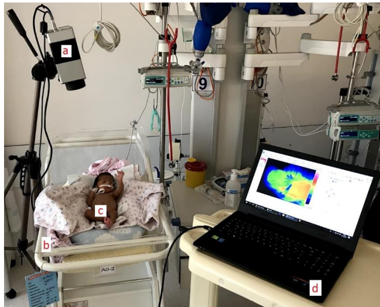
Şekil 3.1. Görüntü almak için oluşturulan sistem (a) kızılötesi termal kamera (b) kuvöz (c) yeni doğan bebek (d) taşınabilir bilgisayar
