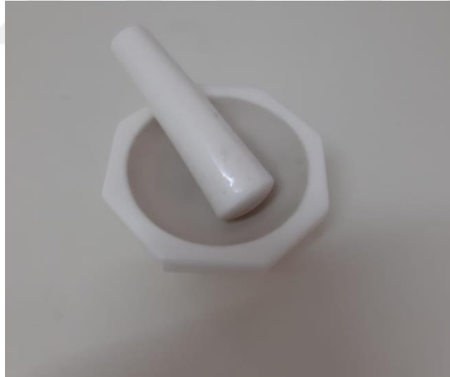
Şekil 3.1. Deney aşamasında kullanılan agat havan
