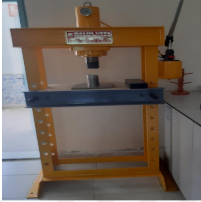
Şekil 3.5. Tek eksenli hidrolik pres
