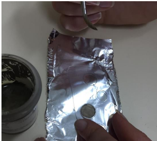
Şekil 3.12. Pelet üzerine kalıp ile gümüş macun sürülmesi
