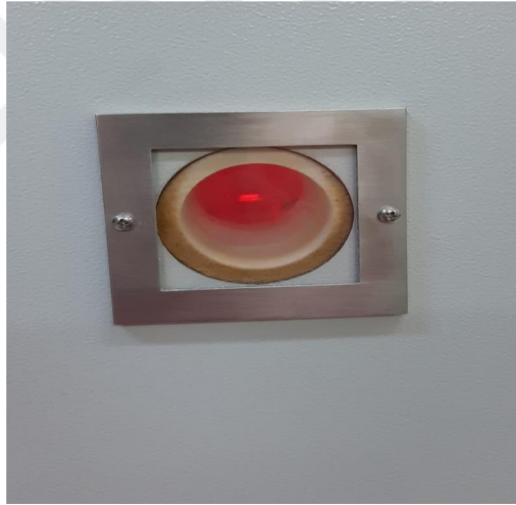
Şekil 3.18. Flash sinterleme deneyinde numunenin parlaması
