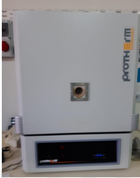
Şekil 3.7. Flash Sinterleme Deneyinde Kullanılan Kamara Fırın
