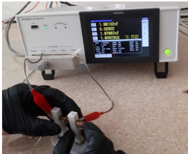
Şekil 3.20. Deney sonrası numunenin LCR-metre ile dielektrik ölçümleri
