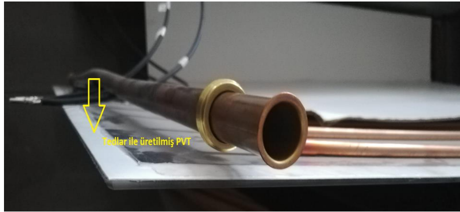
Şekil 3.2 Tedlar kullanılarak üretilmiş PVT paneli
